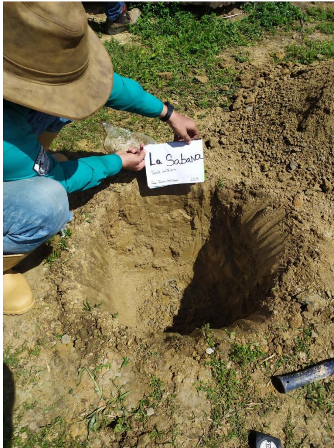
Figura 5.1 Calicata realizada en el pueblo de La Sabana en el sector conocido como "El Faro". La profundidad alcanzada en esta perforación fue de aproximadamente 150 cm.
