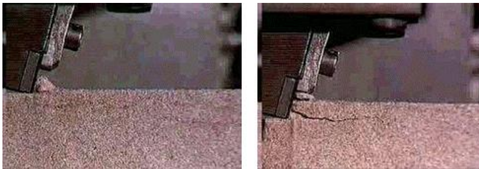
Figura 8. Diferenciación entre los tipos de corte dúctil y frágil. Rodríguez (2004).
