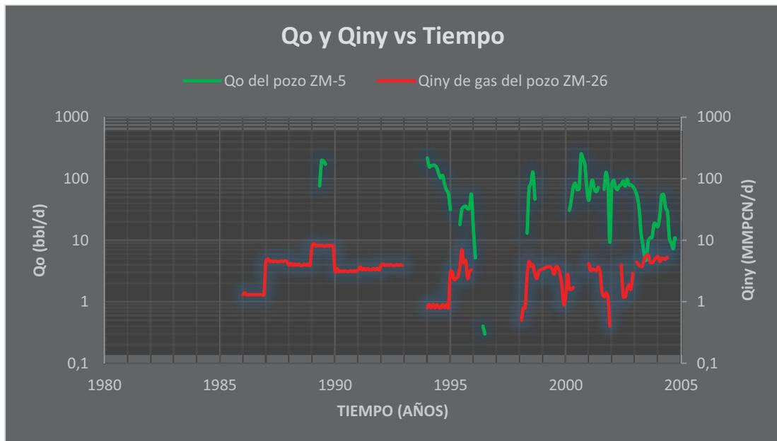
**Figura 59. Tasa de petróleo y de gas inyectado vs tiempo para el pozo ZM-5 asociado al inyector ZM-26**
