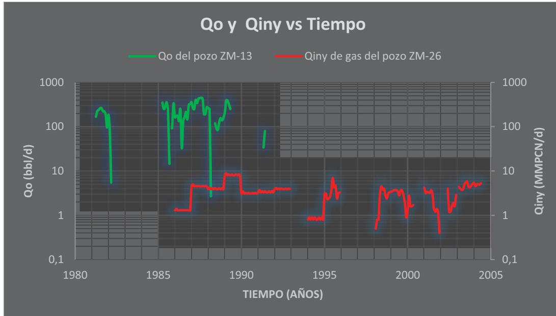
**Figura 60. Tasa de petróleo y de gas inyectado vs tiempo para el pozo ZM-13 asociado al inyector ZM-26**
