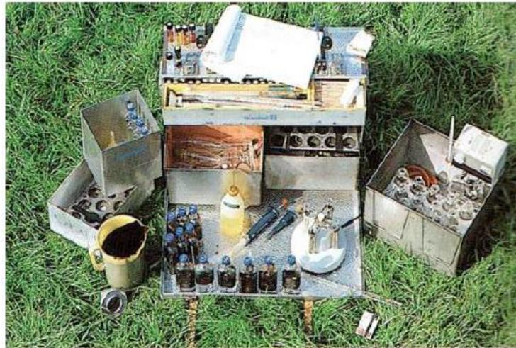
Figura 2.7. Equipo de campo para inyección de demulsificantes (Ramos, 2018).
