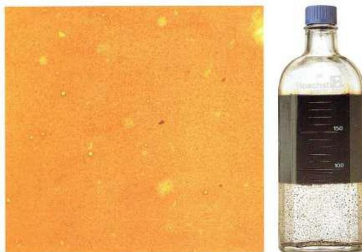
Figura 2.11. Proceso de Deshidratación del Crudo. (Se observa la separación completa de agua y crudo). (Ramos, 2018).
