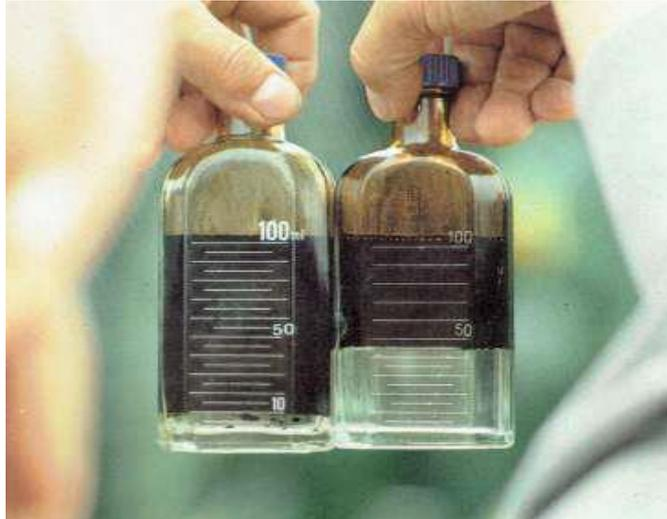
Figura 2.12. Resultado final del demulsificante en la emulsión. (A la izquierda emulsión agua y petróleo, y a la derecha separación de las fases petróleo y agua) (Ramos, 2018).
