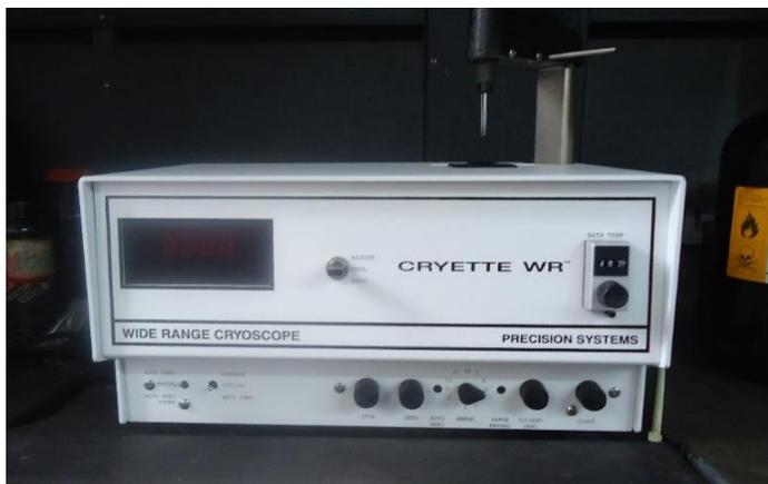
Figura 121. Crioscopio Cryette de rango amplio WR 5009.
