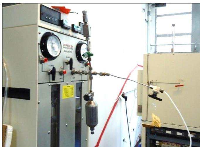
Figura 101. Conexión tipo cruz del gasómetro.
