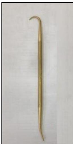
Figura 110. Herramienta especial para remover sellos TFE.
