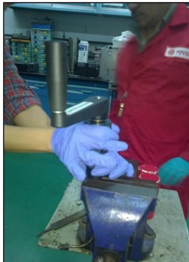
Figura 77. Ajuste de la rosca de la herramienta.
