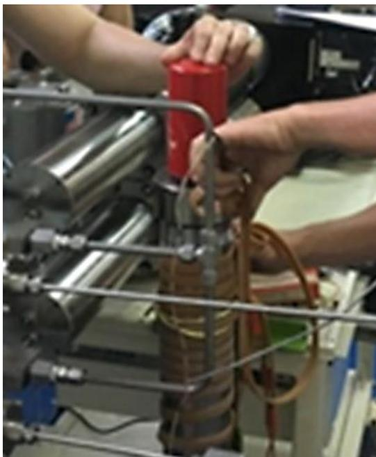
*Figura 111.* Disposición de cintas térmicas alrededor del cilindro portamuestra.
