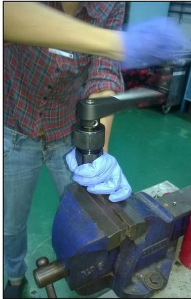
Figura 76. Manipulación de la herramienta para hacer cono.
