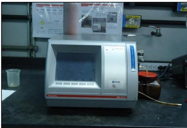
Figura 122. Densímetro digital DMA 4500M.
