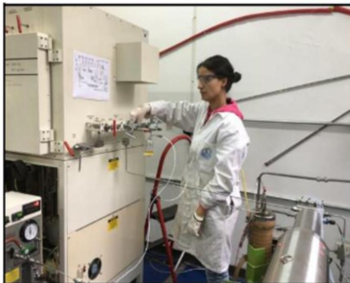
Figura 125. Desplazamiento de volumen de muestra al vial mediante apertura de válvula MV5.
