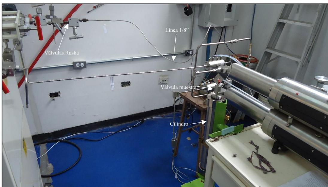
Figura 90. Instalación de las tuberías del cilindro de muestras.
