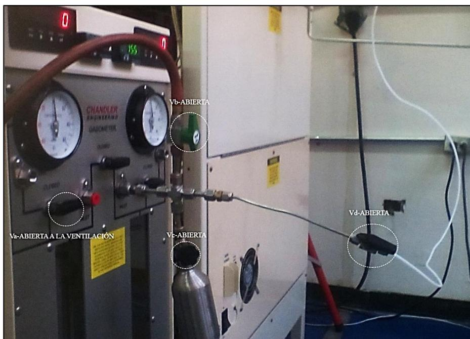
Figura 116. Posición de las válvulas del gasómetro para el vacío.
