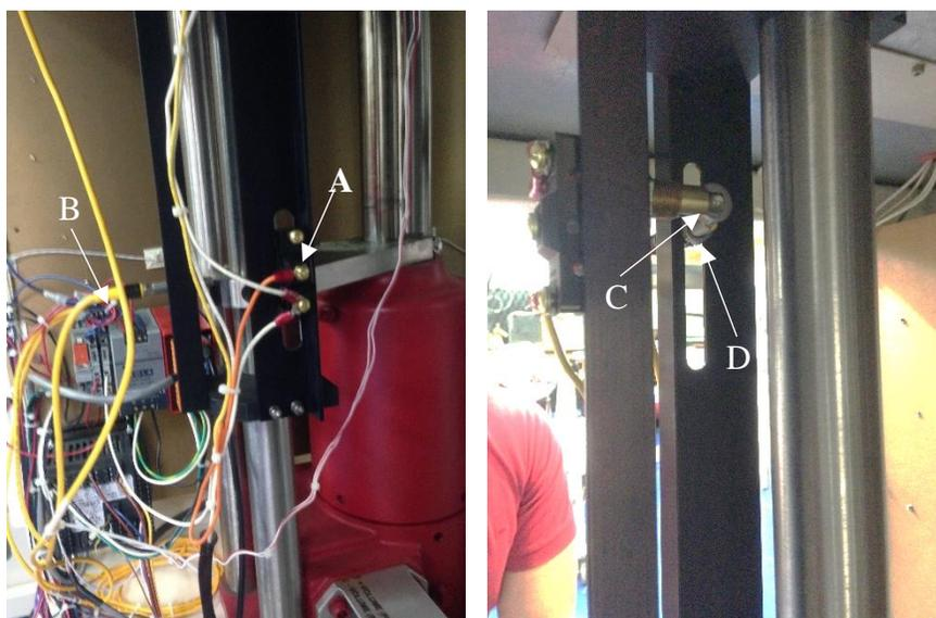
Figura 135. Interruptores y sensores límite para el control de viaje de la celda bomba.
