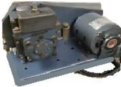
Figura 72. Bomba de vacío modelo 5XB HOOZO.
