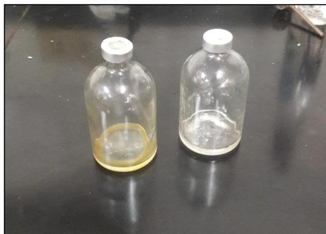
Figura 118. Viales para la recolección de líquido condensado.
