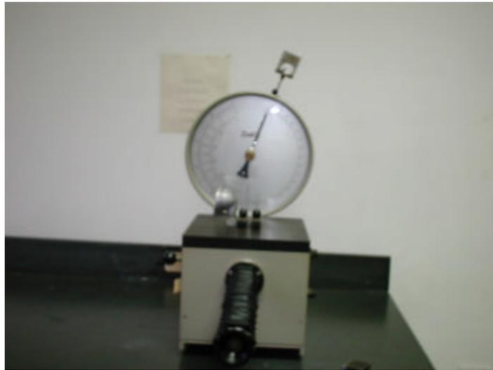
Figura N° 6: Equipo de Ensayo de Impacto tipo IZOD.
