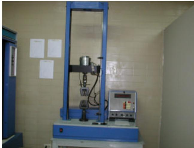
Figura N° 8: Máquina de Ensayos Universales.
