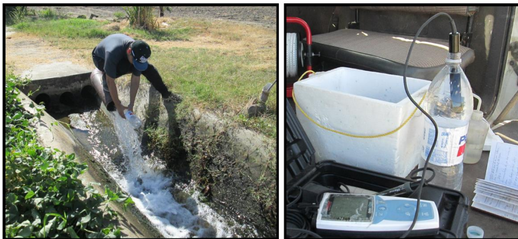
Figura 26. Muestreo y lectura de conductividad en campo, (fotografía tomada en campo)
