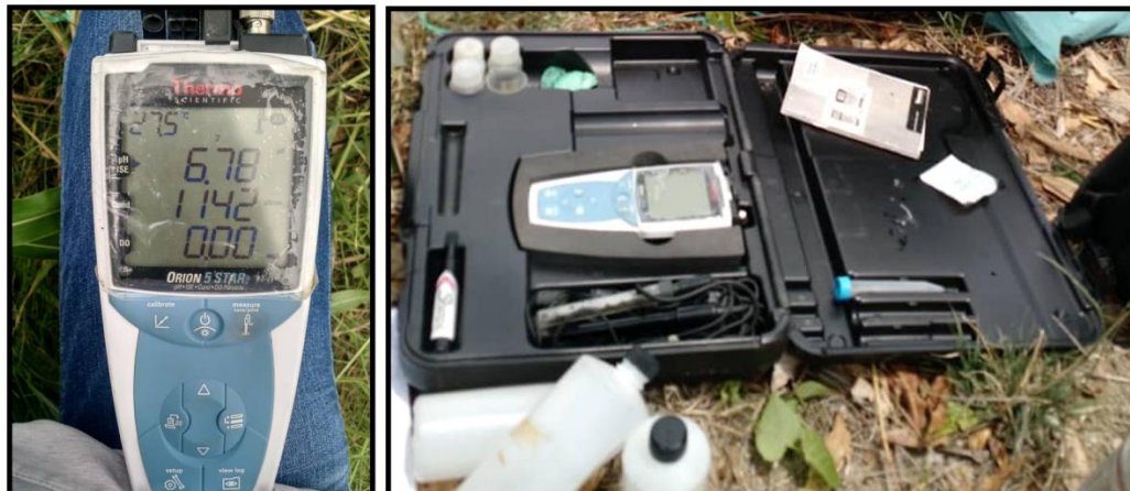
Figura 25. Conductímetro portátil utilizado en campo, (fotografía tomada en campo)
