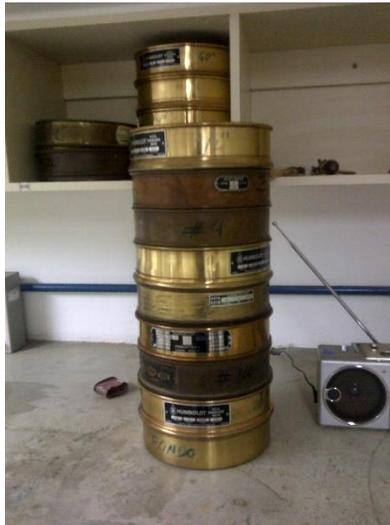
*Figura 5. Tamices para análisis granulométrico*
