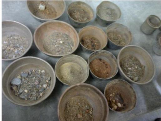
**Figura 6.** Muestras para análisis granulométrico
