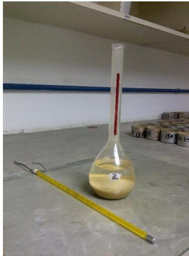
Figura 10. Muestra para ensayo de peso específico
