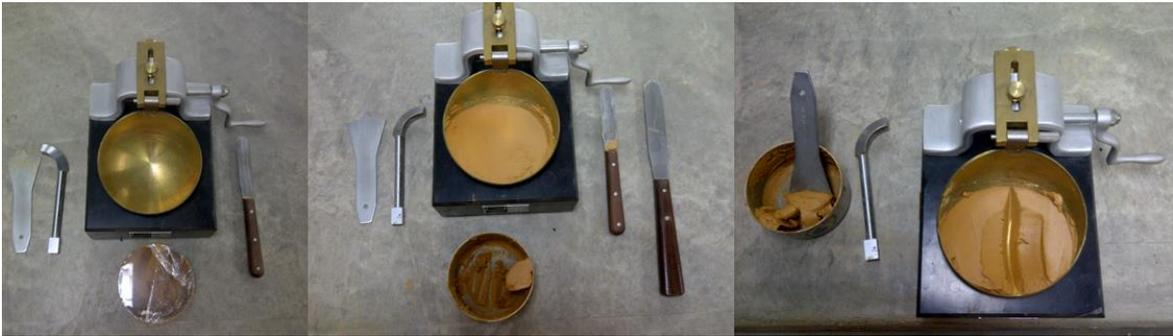
Figura 11. Equipo y muestras para ensayo de límite líquido
