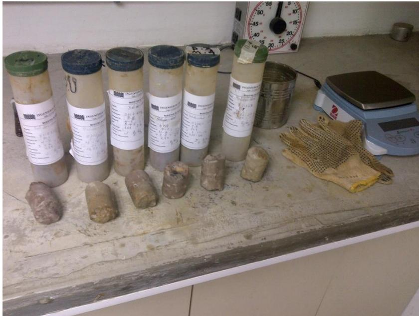
Figura 9. Muestra para ensayo de peso unitario
