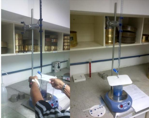
Figura 13. Equipo y muestras para ensayo de azul de metileno
