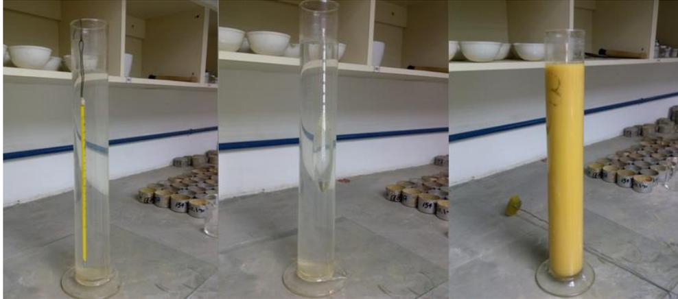
**Figura 8.** Equipo y muestras para ensayo de granulométrica por hidrómetro
