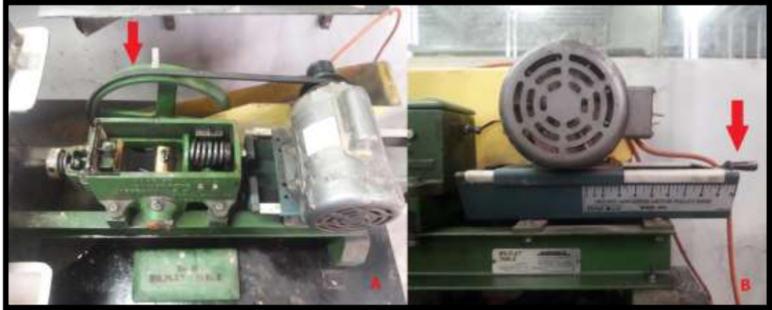
Fig. 22: A. Polea que conecta motor con mecanismo; B. Perilla que controla la velocidad de la superficie de la mesa, Laboratorio de Beneficio Mineral de la Escuela de Geología, Minas y Geofísica.
