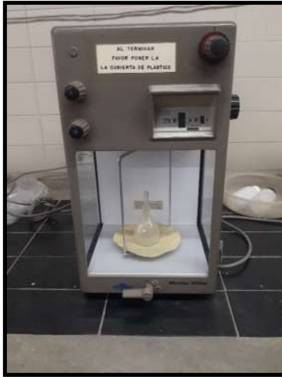
Fig. 17: Balanza analítica Mettler H10W y Picnómetro, Laboratorio de Beneficio Mineral de la Escuela de Geología, Minas y Geofísica.
