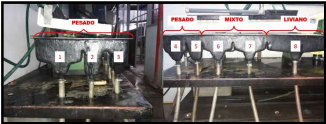
Fig. 23: Sistema de recolección de material, Laboratorio de Beneficio Mineral de la Escuela de Geología, Minas y Geofísica.
