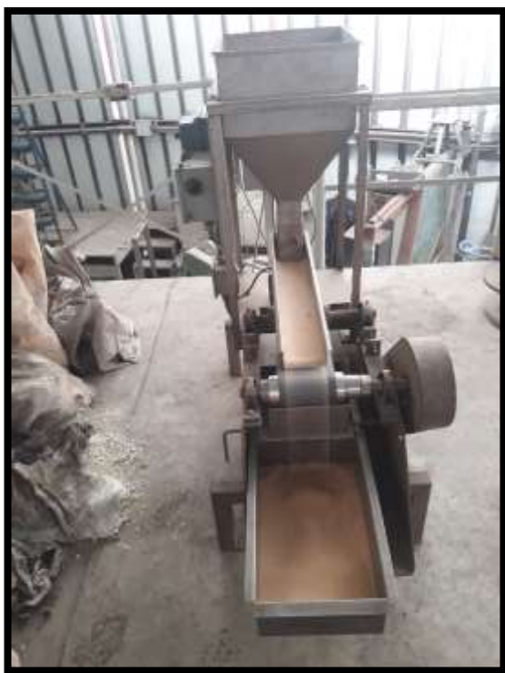
Fig. 25: Concentrador magnético marca Eriez, Laboratorio de Beneficio Mineral de la Escuela de Geología, Minas y Geofísica.
