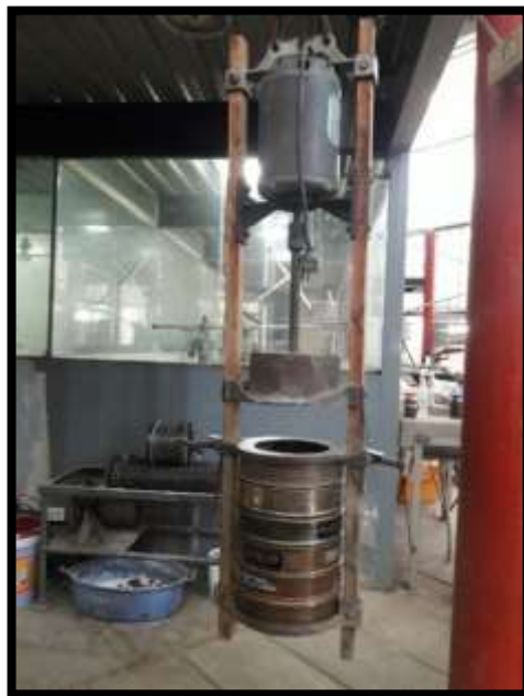
Fig. 15: Agitador de tamices marca Doerr y tamices estandarizados A.S.T.M, Laboratorio de Beneficio Mineral de la Escuela de Geología, Minas y Geofísica.
