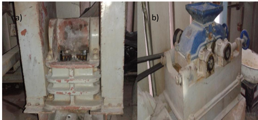
Trituradora de mandíbula (11 x 14) cm. b) trituradora de rodillo lisos Ø=9"(22,86cm). Laboratorio de beneficio mineral UCV.
