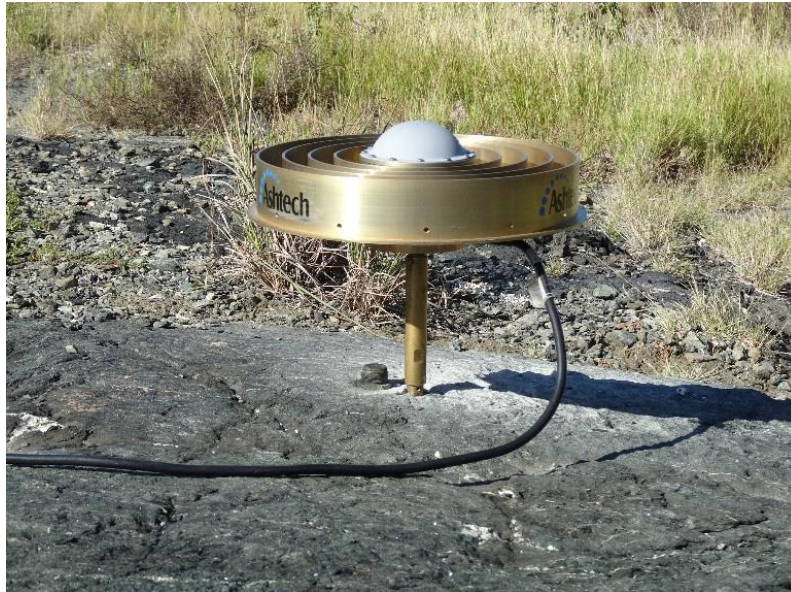
Figura 3.2. Antena modelo Choke Ring Ashtech instalada en el vértice MAN1 (Punta Manzanillo, Nueva Esparta). El dispositivo de rosca externa se encontró degradado por vandalismo en la misión de reconocimiento de 2013 (se observa ligeramente a la izquierda de la extensión de la antena) y fue sustituido por un modelo de rosca interna (Tomado de Reinoza et al., 2017).
