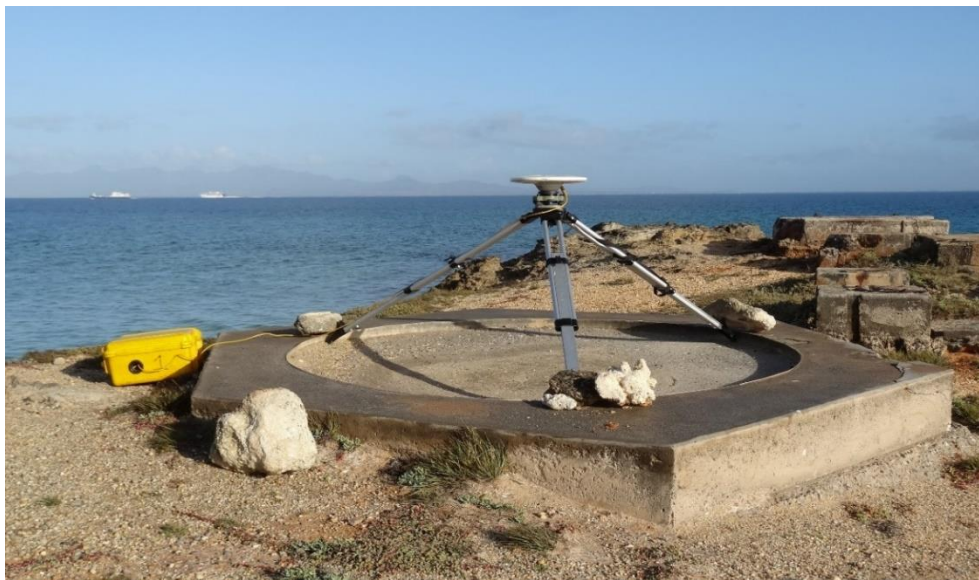
Figura 3.4. Estación CHA0 (Charagato, Isla de Cubagua). Receptor: Trimble 5700 y antena: Zephyr Geodetic Trimble, instalada de forma convencional sobre un trípode topográfico. Crédito fotografía: Franck A. Audemard.
