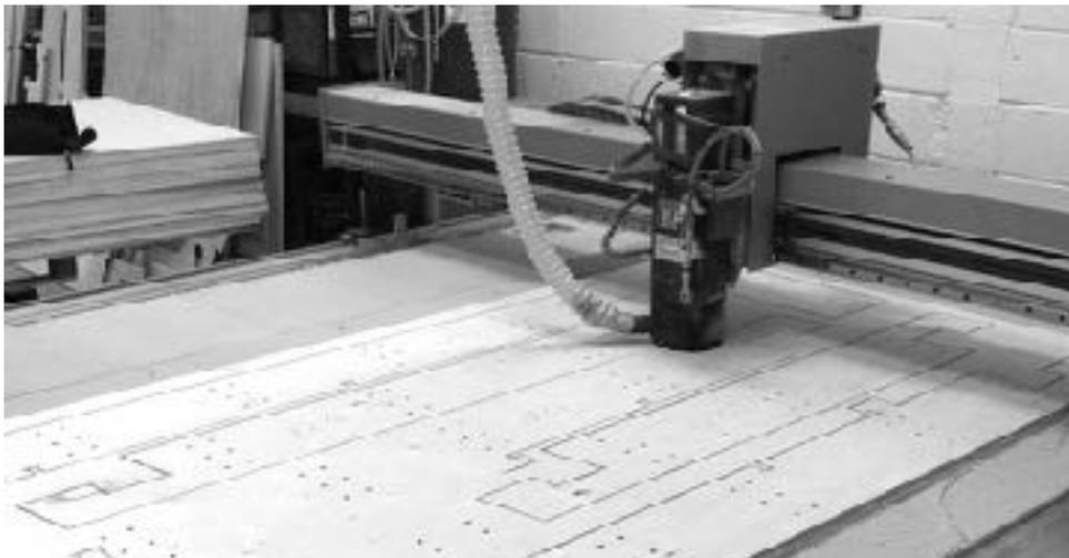
Ilustración 3.7 Cortadora Láser fabricando las piezas para la WikiHouse
