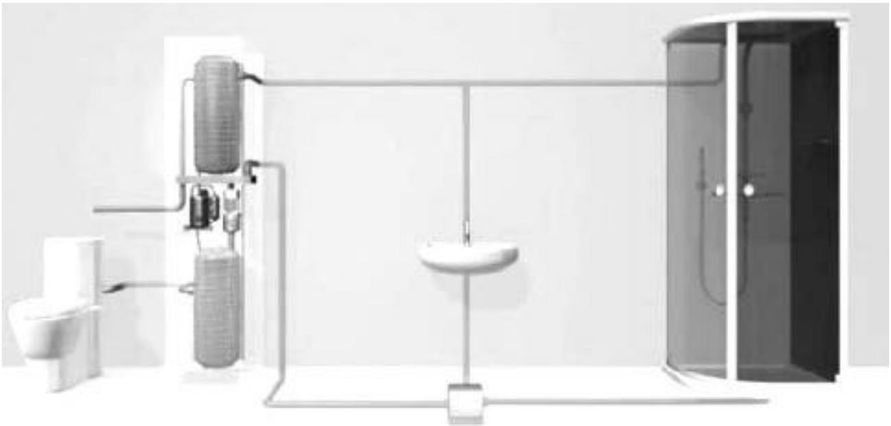
Ilustración 3.18 Esquema de funcionamiento del sistema de recuperación de aguas grises
