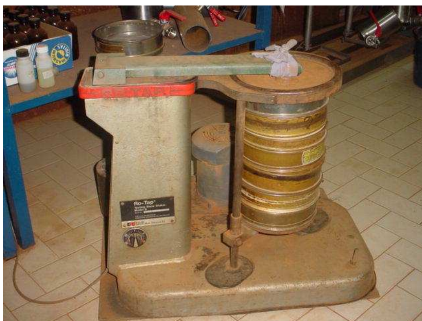
Figura 3.8 Máquina de tamizaje Ro-Tap en conjunto con serie de tamices
