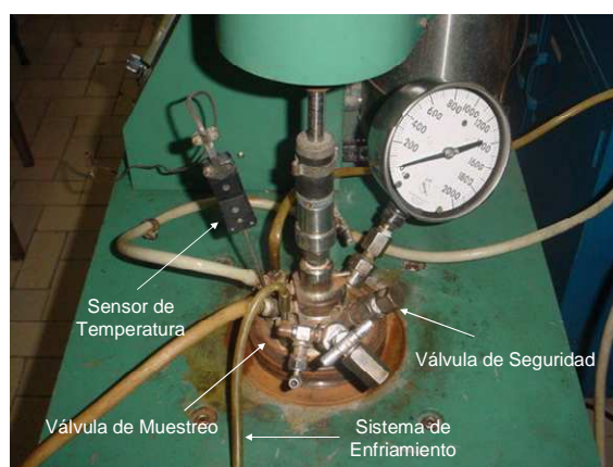
Figura 3.11 Vista superior del sistema de válvulas del autoclave PARR.
