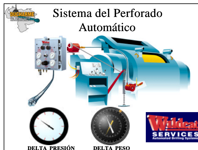
Fig. 54.- Sistema del perforador automático. (24)
