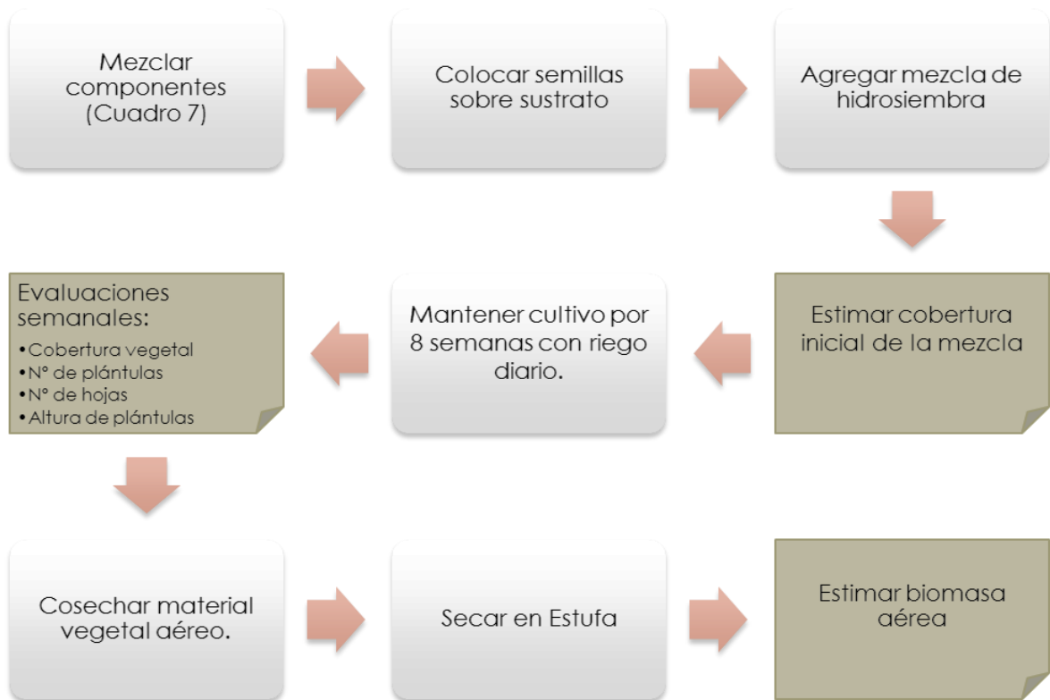
Figura 3. Esquema del experimento en bandejas tipo A para evaluar el establecimiento vegetativo desarrollado en las mezclas de hidrosiembra.
