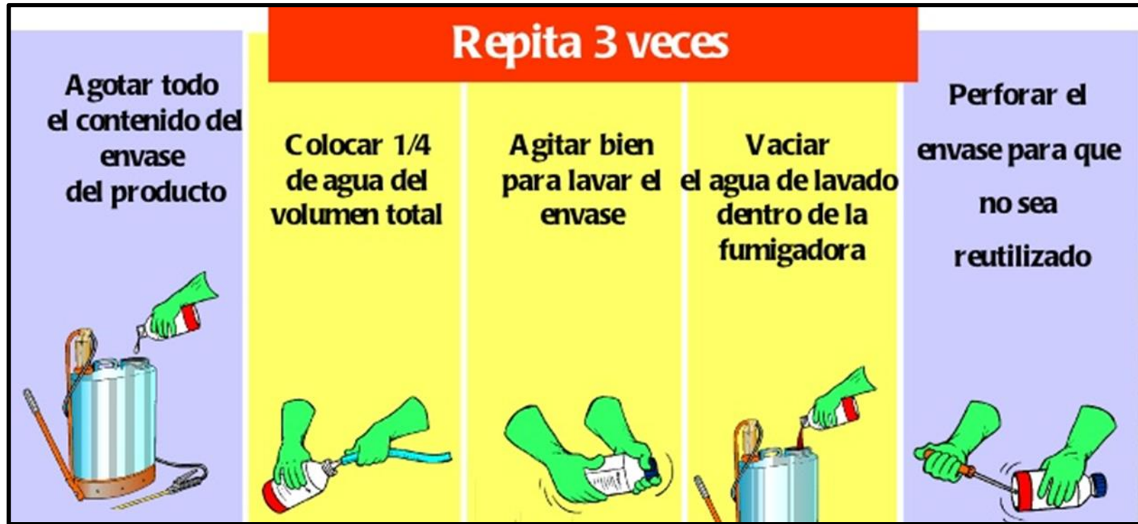
Figura 7. Triple lavado y perforación de envases vacíos de plaguicidas.
