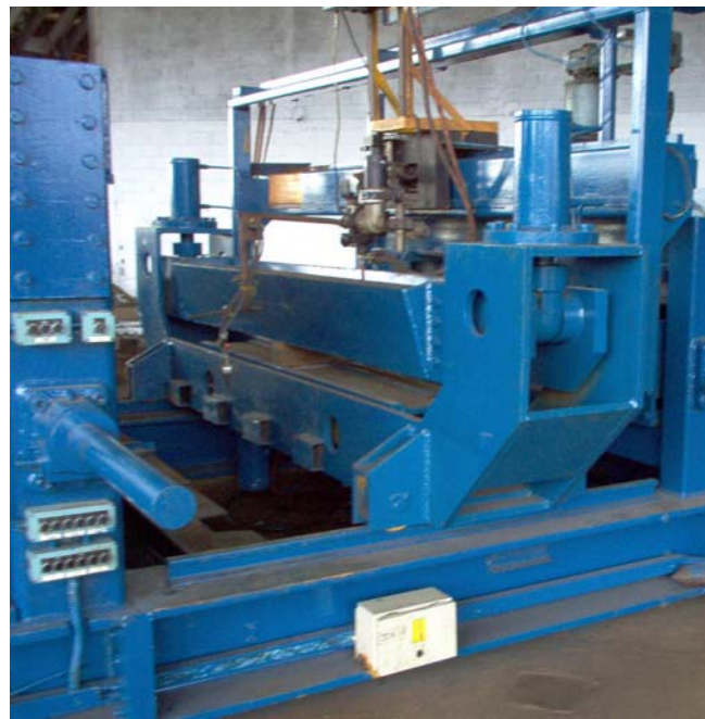
Figura 24 - Mesa de Empalme colocada sobre la Sección A del Bastidor de Entrada.
