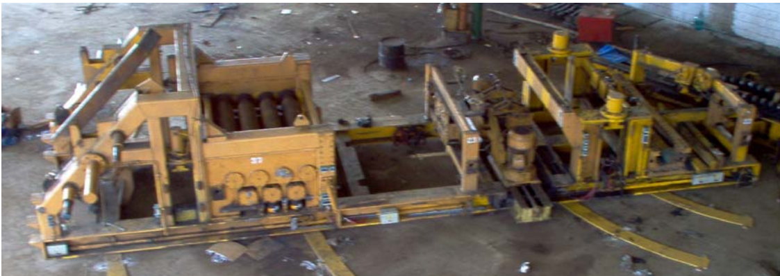
Figura 16 - Montaje de los Rodillos de Tracción en la Sección B del Bastidor de Entrada.
