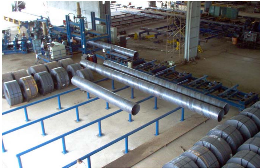
Figura 26 - Tubos de 30" fabricados durante la calibración.
