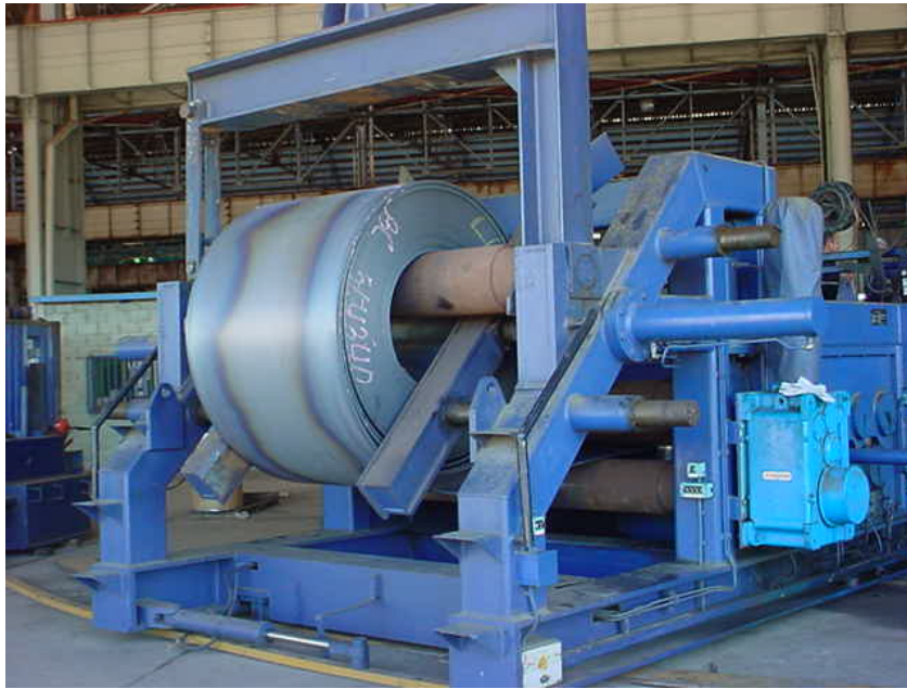
Figura 1 - Imagen de la bobina montada en el Porta Bobina
