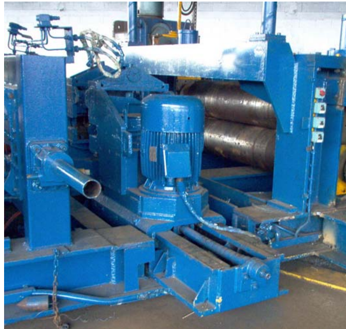
Figura 23 - Detalle de la Fresadora instalada en la Sección A del Bastidor de Entrada.
