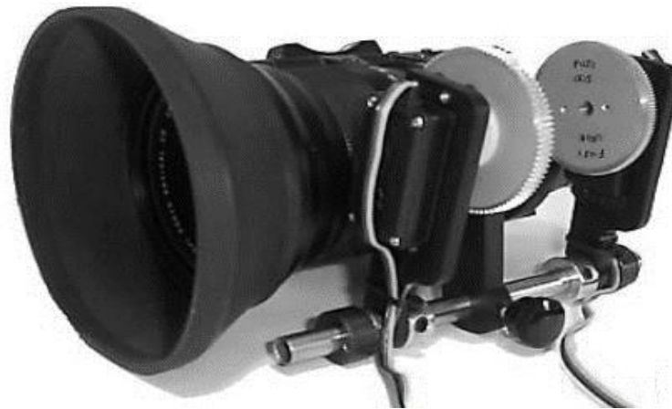
Figura 47. Mecanismo ajustado al lente de la cámara (control de foco e iris). [74]
