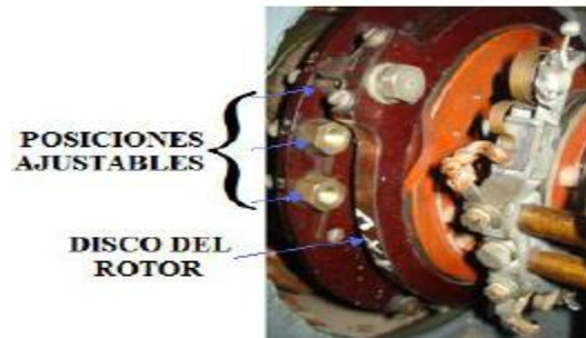
Figura 8. Disco ajustable del rotor de la máquina generalizada. [4]
