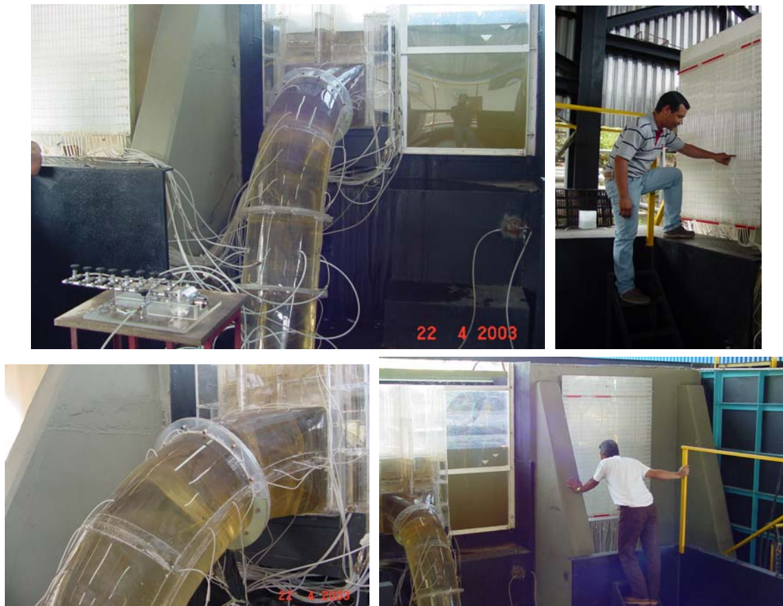
FIGURA 3.11.- Esquema de medición de presiones piezométricas
