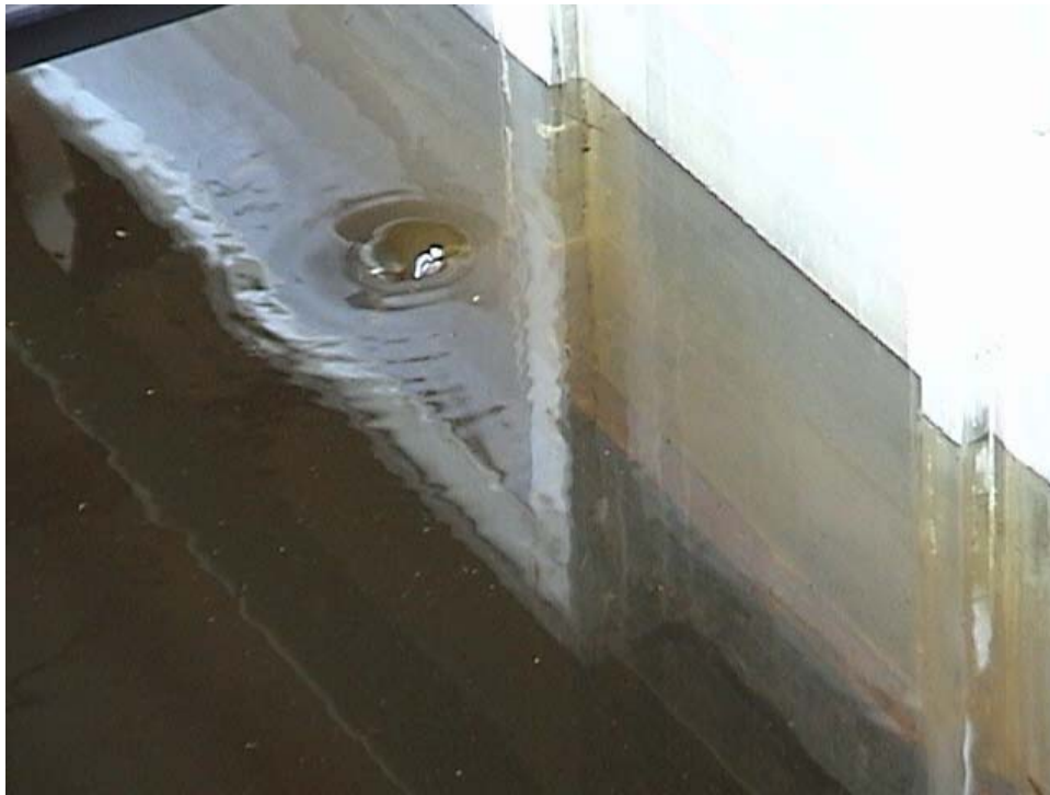
FIGURA 3.35.- Caso 3, vórtices tipo 6 permanente, Q_{\text{prot}}=1400 \text{ m}^3/\text{s} , El.=255,00
