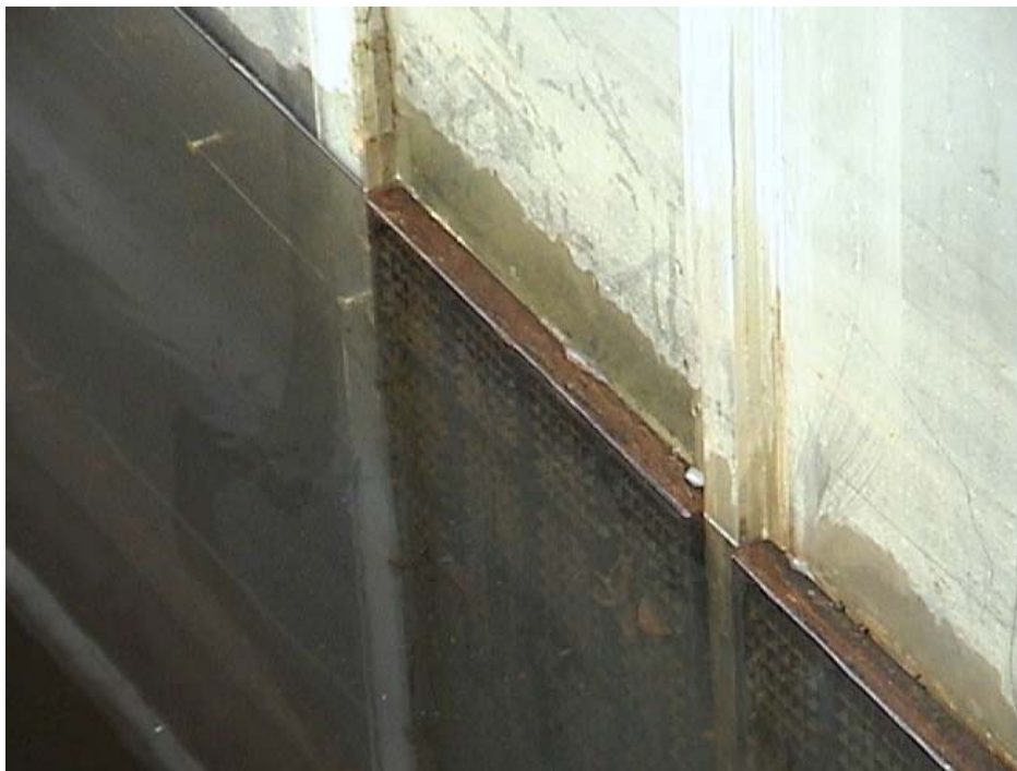
FIGURA 3.33.- Caso 3, vórtice tipo 1 esporádico, Q_{prot}=600 m^3/s , El.=237
