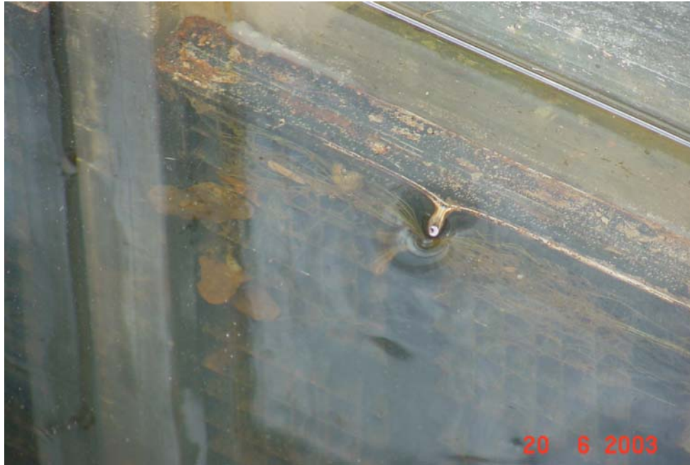
FIGURA 3.26.- Caso 1, vórtices tipo 5 cuasi-permanentes , Q_{\text{prot}}=1.400 \text{ m}^3/\text{s} , El.=237
