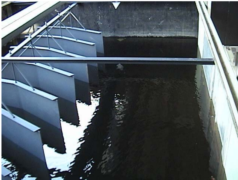
FIGURA 3.27.- Arreglo de álabes móviles para simulación del Caso 2
