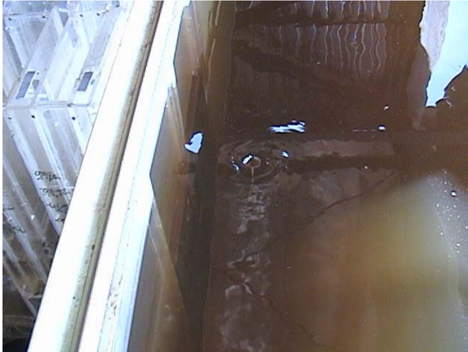
FIGURA 3.34.- Caso 3, vórtices tipo 5 frecuente , Q_{\text{prot}}=1000 \text{ m}^3/\text{s} , El.=255
