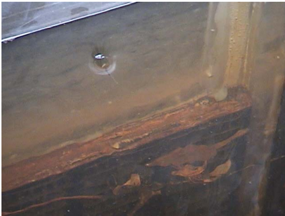
FIGURA 3.30.- Caso 2, vórtices tipo 5 frecuente , Q_{\text{prot}}=1200 \text{ m}^3/\text{s} , El.=246
