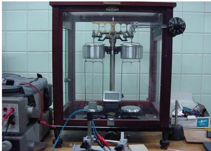
FIGURA N° 15 BALANZA CON LA QUE SE APLICO EL MÉTODO DE LA FUERZA
