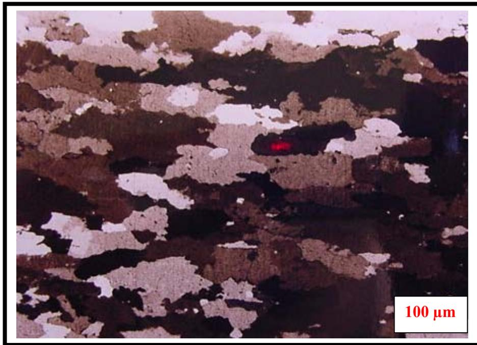
FIGURA N° 23. MICROFOTOGRAFIA OPTICA N° 5. AUMENTO 50X . PROBETA N° 60. MUESTRA RECRISTALIZADA AL 22 %.
