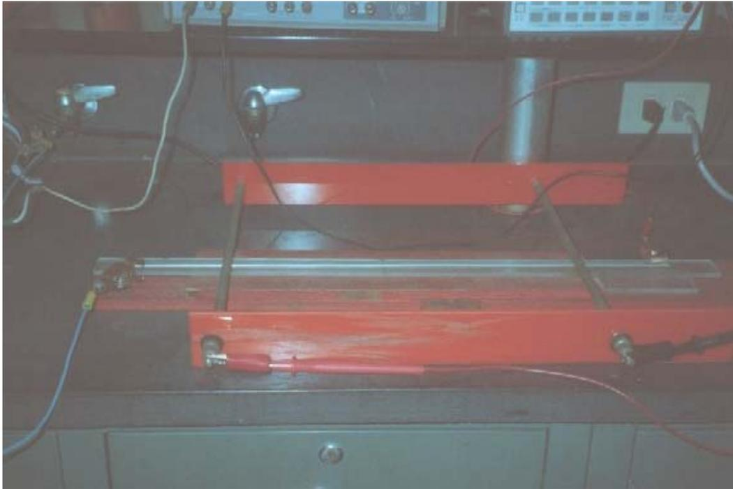
FIGURA . N° 11 MONTAJE PARA MEDIR LAS PROBETAS CON EL METODO DE LAS 4 PUNTAS
