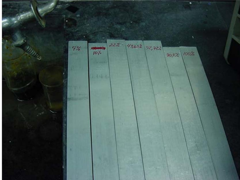
FIGURA N° 9. SEGUNDO GRUPO DE PROBETAS LISTAS PARA LA APLICACIÓN DE LOS METODOS DE ENSAYOS NO DESTRUCTIVOS
