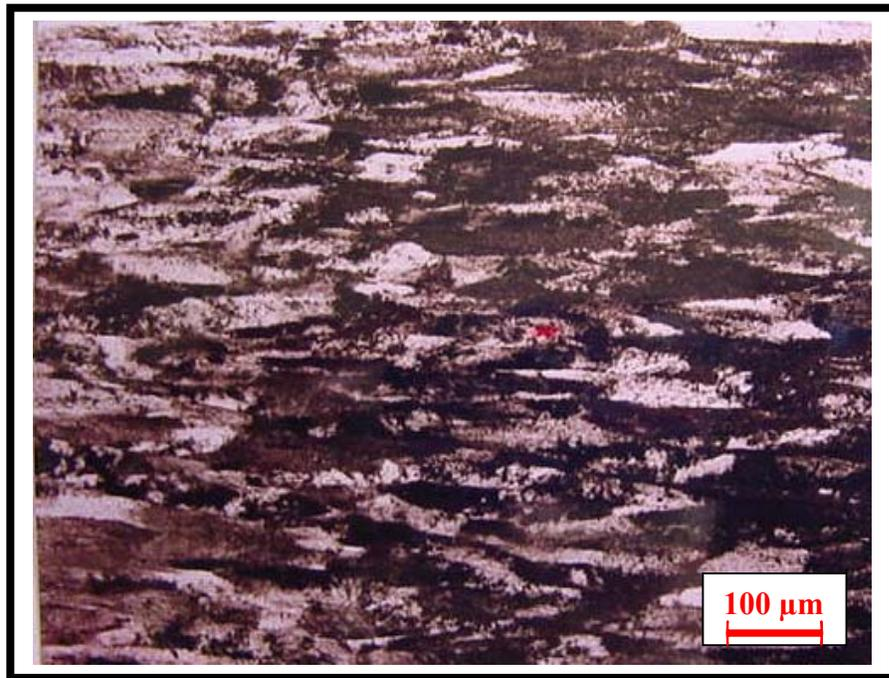
FIGURA N° 20. MICROFOTOGRAFIA OPTICA N°2. AUMENTO 50X .
