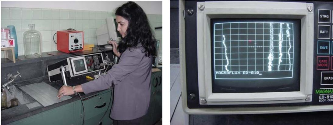
FIGURA N° 13. APLICANDO CORRIENTES INDUCIDAS. VALORES EN LA CUADRICULA DEL INSTRUMENTO DE DIAGRAMA DE IMPEDANCIA.
