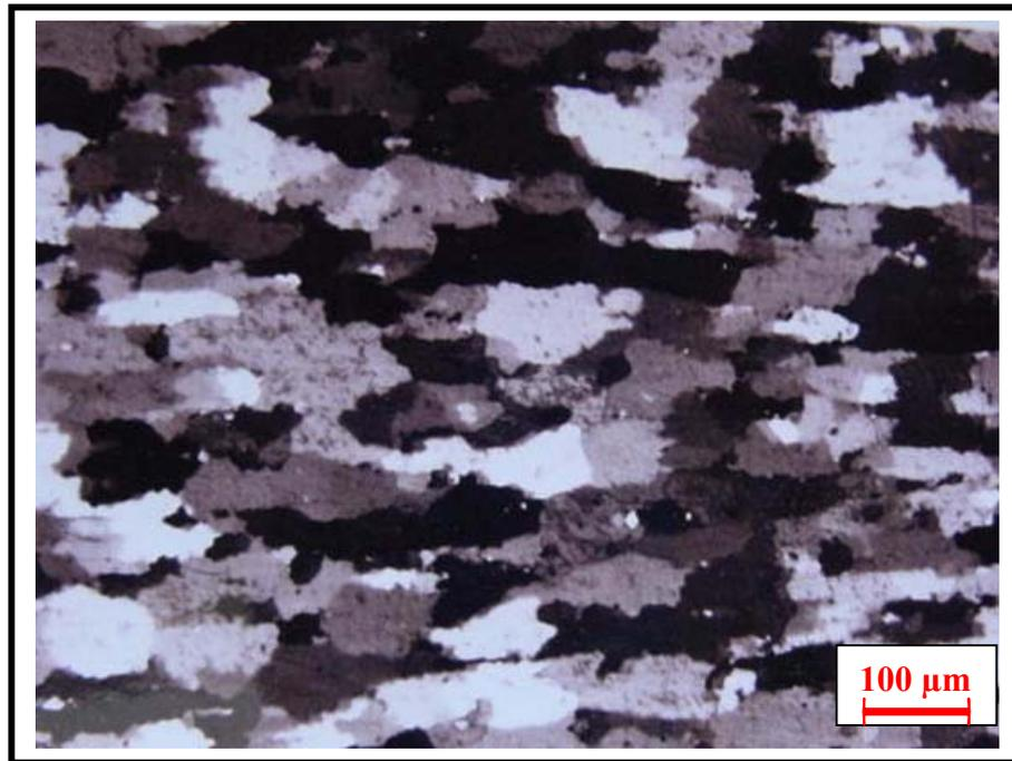
FIGURA N° 25. MICROFOTOGRAFIA OPTICA N° 7. AUMENTO 50X . PROBETA N° 63. MUESTRA RECRISTALIZADA AL 52,72 %
