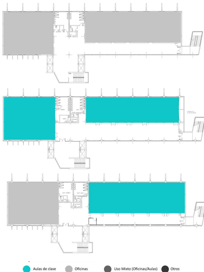
Ilustración 4-2 Distribución de la ocupación actual del piso 8, piso 1 y planta tipo de aulas (En sentido descendente) del conjunto de la FAU Fuente: Elaboración Propia
