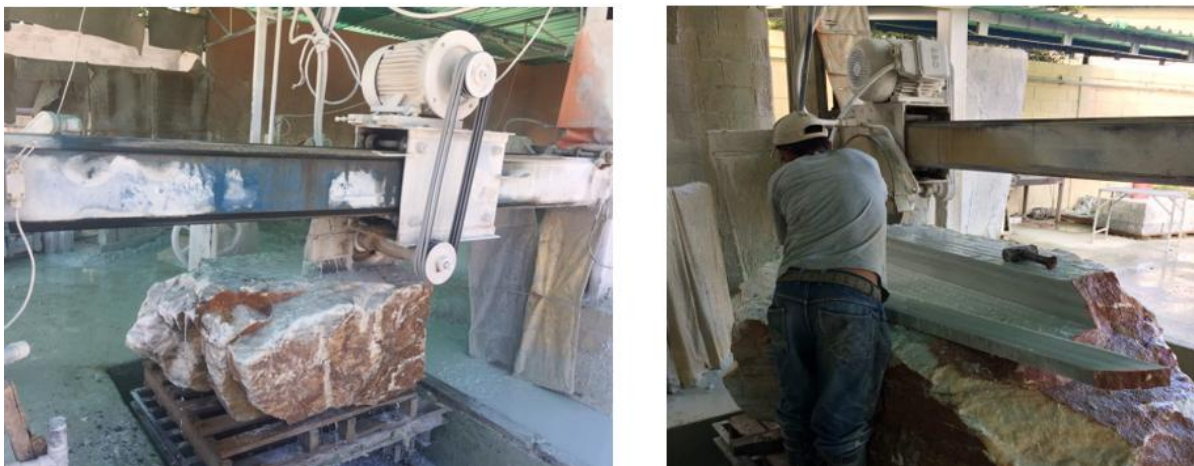
Figura 5.3. Montaje de Bloques en el equipo de corte
