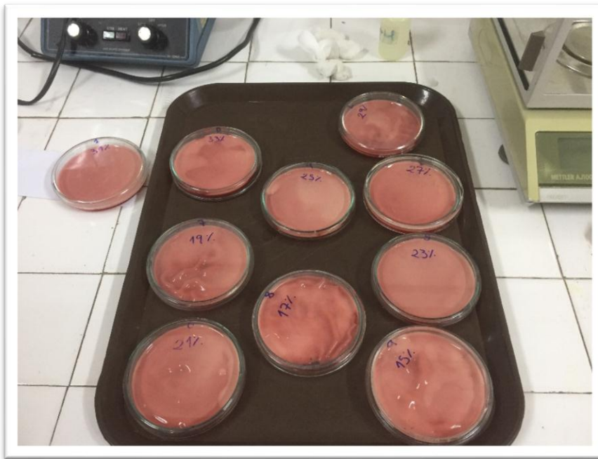
Figura 4.2. Phantom realizados en laboratorio con concentraciones: 33%, 31%, 29%, 27%, 25%, 23%, 21%, 19%, 17% y 15%.
