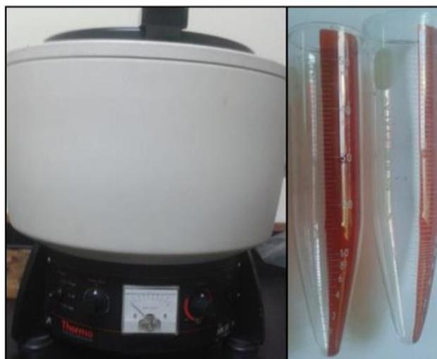
Figura 11. Centrifugadora modelo Thermo Electron Corporation modelo IEC HNS II utilizada (Tomado de Casanova, 2017).
