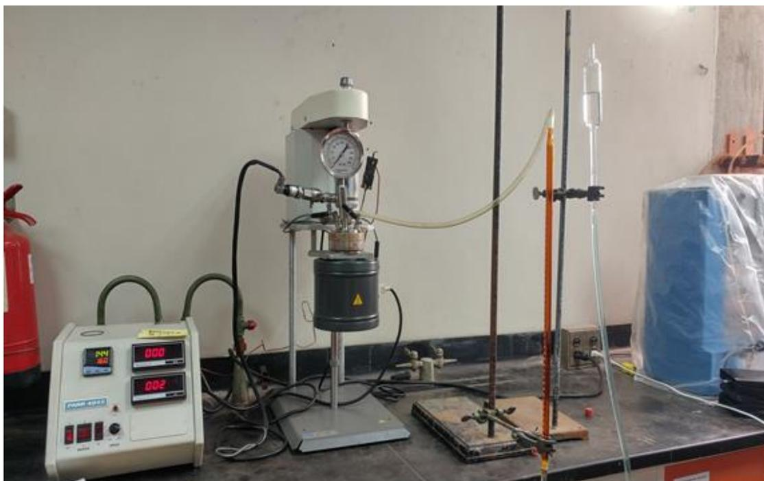
Figura 12. Montaje experimental para la desorción de gases utilizando un reactor de calentamiento
