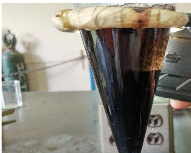
Figura 28. Separación de Vitrinita de alta densidad de la Fm. Cerro Pelado.
