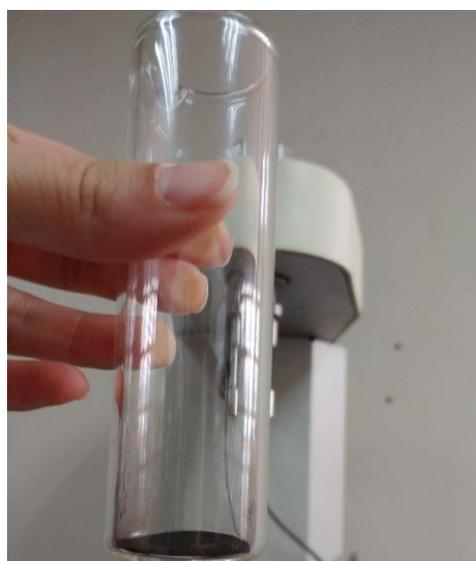
Figura 30. Muestra de vitrinitas de alta densidad contenida en el vaso del reactor Parr, para su cuantificación del volumen de gas desorbido. No se observa humedad luego de la prueba.
