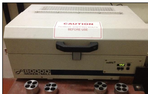
Molino de bolas de acero, modelo SPEX 8000D
