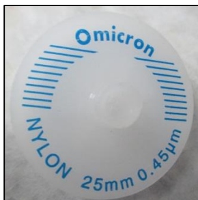
Filtros de nylon de 0,45 \mu\text{m} . Micron. D= 25 mm
