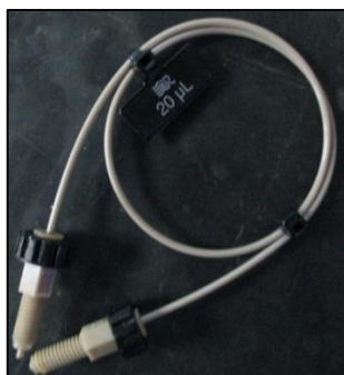
Lazo de inyección de 20 \mu\text{L} para puerto de inyección del HPLC.
