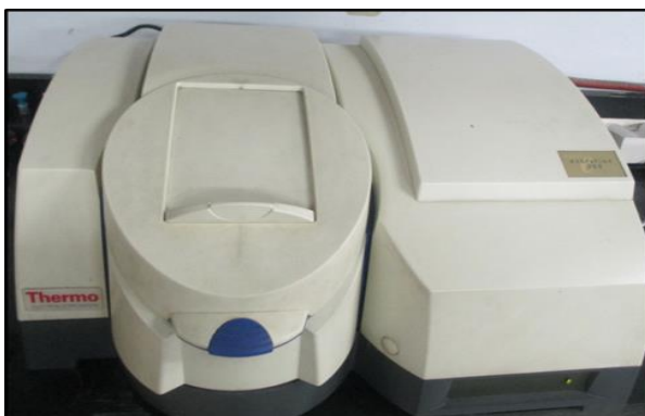
Espectrofotómetro de UV/VIS Thermo Electron Corporation ® Evolution TM 300.
