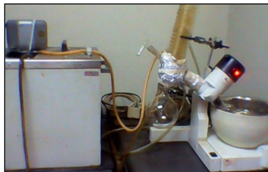
Rotavapor Fisatom acoplado a un chiller Haake KT-33
