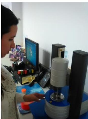
Figura 9. Thermo Scientific HAAKE equipado con un RotoVisco
