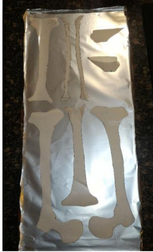
Figura 5.15: En las fotos se observa a la izquierda los patrones que serán utilizados para cortar los artefactos con las formas anatómicas de las estructuras óseas necesarias y en la foto de la derecha se observa el vaciado con gelatina sobre el molde plano de papel de aluminio.
