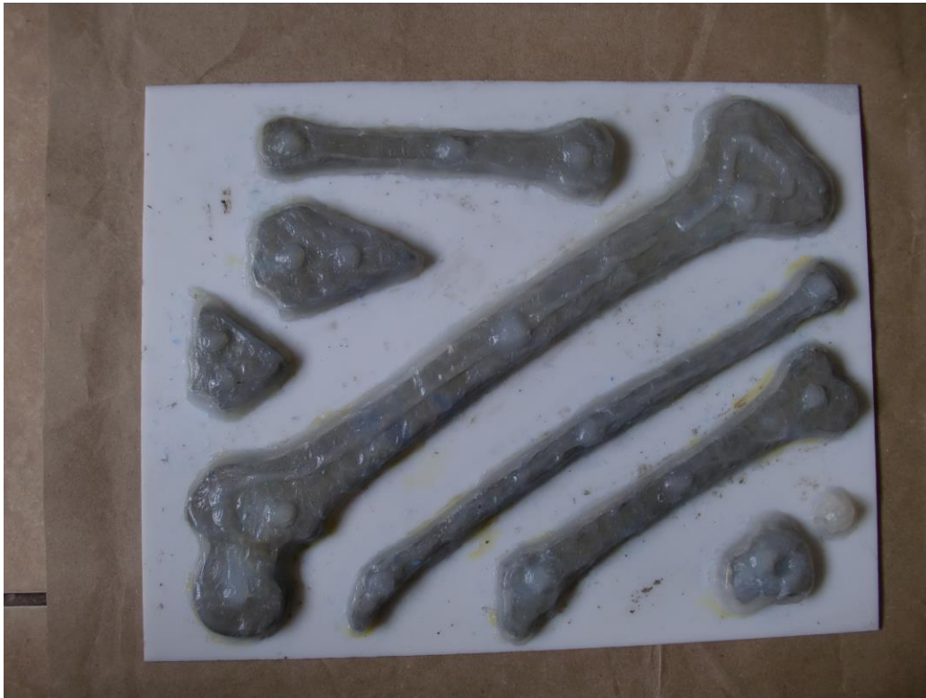
Figura 5.24: en la foto se observa el fémur, peroné y pie de adulto, sobre el mismo marco se puede ver el fémur, peroné, cadera y pie de un niño, todos en plastilina y cubiertos con una capa de silicona, sobre las cuales se coloco botones de silicona para establecer los puntos de anclaje con el yeso que servirá de base para los moldes.
