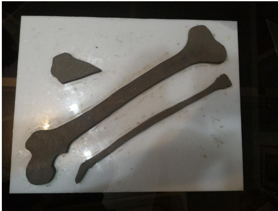
Figura 5.23: En la figura se observa el pie, el fémur y el peroné, en plastilina con el espesor de 2 cm, necesario para lograr la atenuación requerida del haz de radiación.
