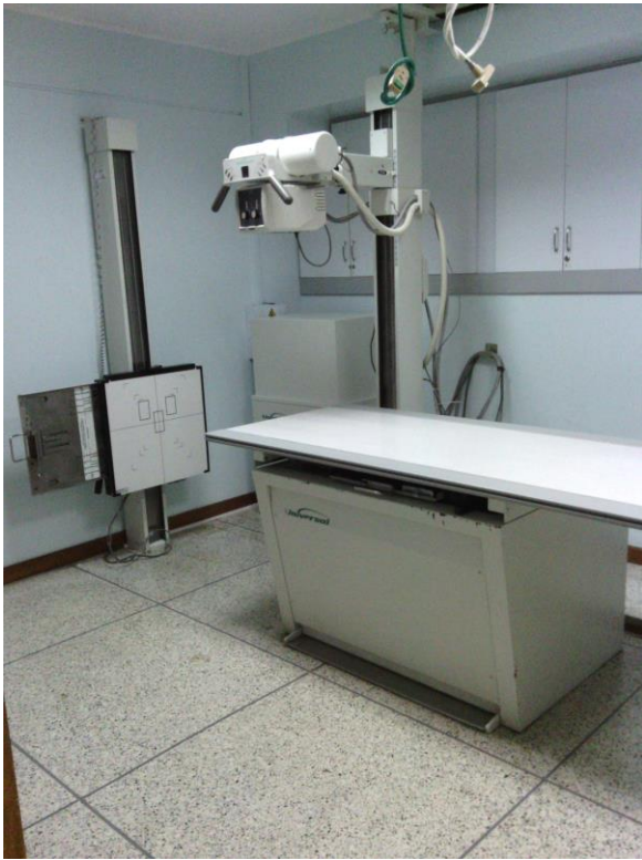
Figura 2.5: Equipo de Rayos x convencional, formado por la mesa, bucky de pared, tubo de rayos x y transformador
