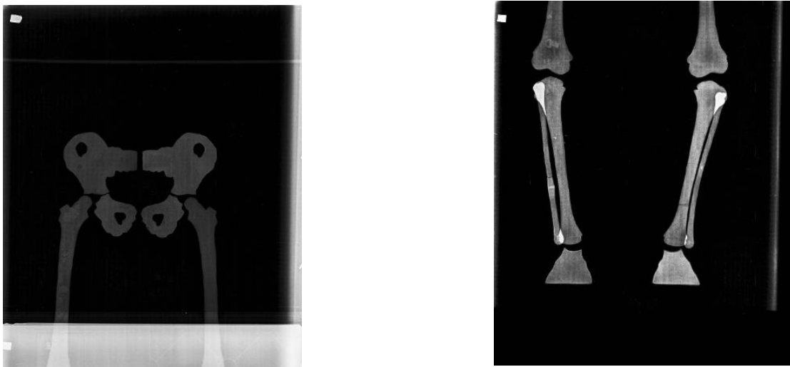
Figura 6.25: En las figuras se observa las rayos x de panorámica de miembros inferiores del maniqué que simula un paciente con genu valgus, de izquierda a derecha se ven en la primera imagen los artefactos que simulan la cadera, fémur y en la imagen de la derecha se observan los artefactos que simulan tibia, peroné y los pies.
