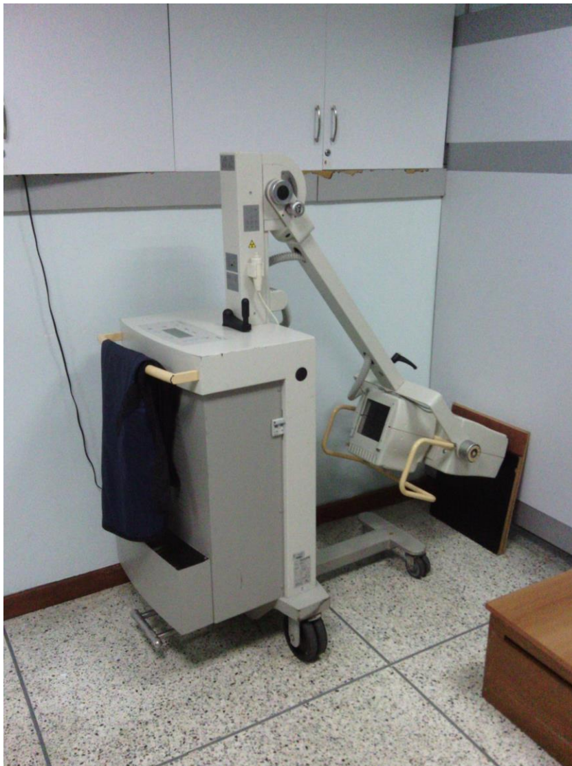
Figura 2.9: en la figura de muestra un equipo portátil, el cual cuenta con un sistema de ruedas direccionables con una palanca y un transformador de alto voltaje que alimenta al tubo de Rayos X, con un colimador y un disparador con cable extensible, y sistema de control remoto opcional.
