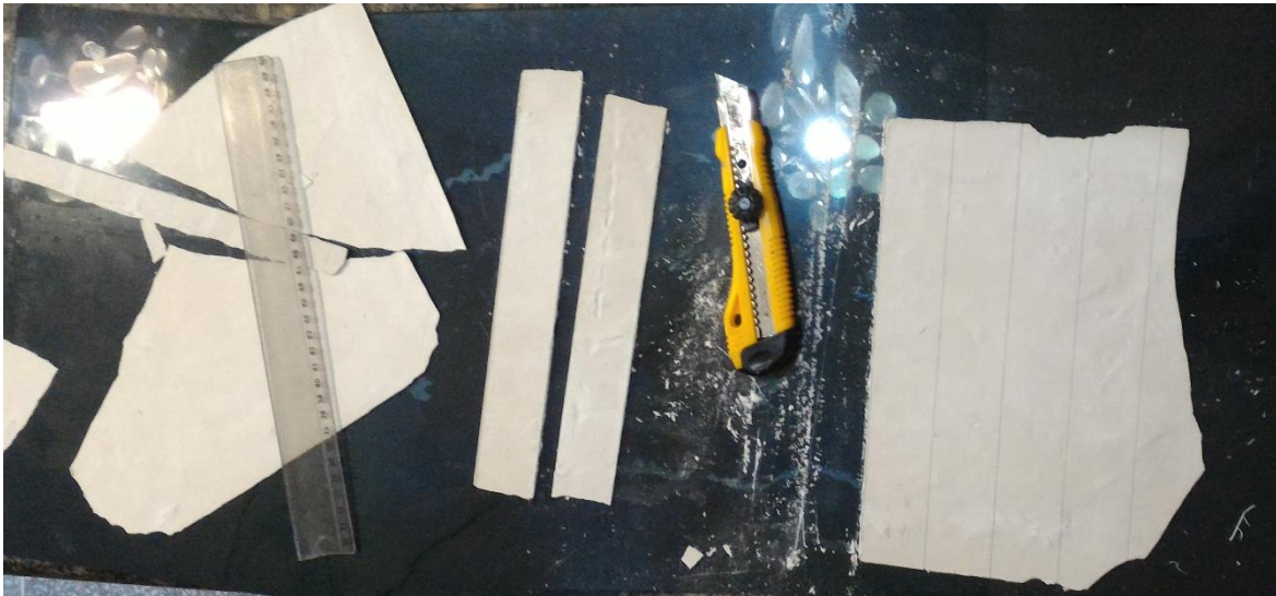
Figura 5.16: En la foto se observa una lámina de yeso con espesor de 2mm que es cortada en láminas de 5cm de ancho y se usaran para fabricar una escala de contraste con la finalidad de determinar el espesor de yeso necesario para simular la atenuación aproximada del hueso.
