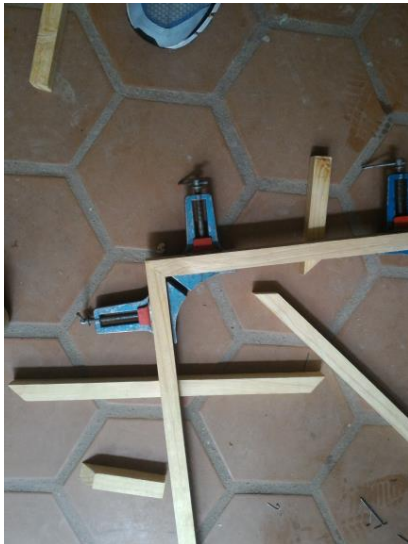
Figura 5.29: En las figuras se muestra el soporte que mantiene alineado a 90 grados los listones mientras se seca el pegamento.
