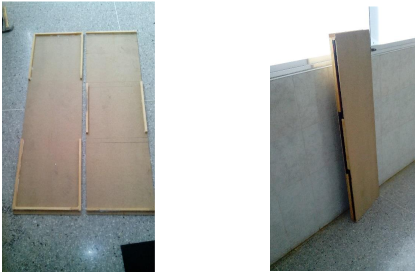
Figura 5.4: en la foto se muestra el bucky en dos partes ya listo para acoplar y totalmente ensamblado.
