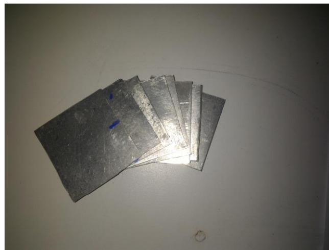
Figura 4.4: Se observan las 8 láminas de aluminio con espesor de 1mm y lados de 5 cm, utilizadas para determinar el espesor hemireductor del equipo de Rayos X.
