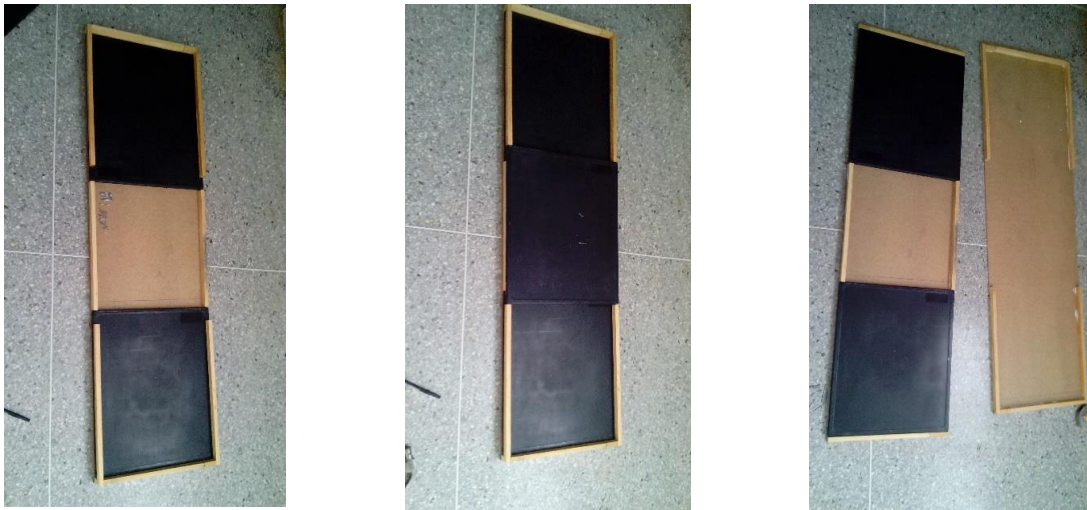
Figura 5.3: en las fotos se muestra el proceso de ensamblaje del bucky de miembros inferiores y como se distribuirán los chasis en su interior.
