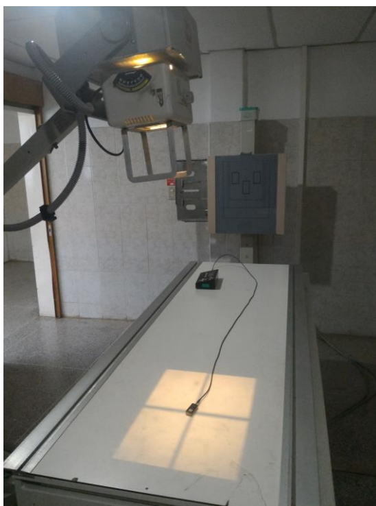
Figura 4.2: En la figura de muestra la ubicación del detector en el centro del retículo del haz luminoso.
