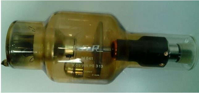
Figura 2.1: El tubo de rayos X funciona básicamente mediante un filamento de wolframio (cátodo), al aplicar una corriente eléctrica, se calienta a grandes temperaturas, generando así un flujo de electrones que son acelerados hacia el ánodo de wolframio por medio de un voltaje, de lo cual se desprende radiación infrarroja y rayos X.
