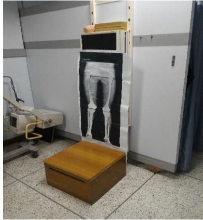
Figura 5.17: En las fotos se observa la primera prueba ejecutada con los artefactos realizados con yodo sobre papel, se procedió a ubicar sobre el bucky y efectuar una adquisición con técnicas estándar para un paciente adulto.
