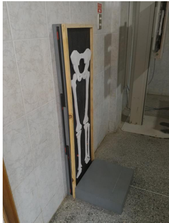
Figura 6.8: En las fotos se observa el maniquí posicionado para la adquisición de las imágenes, en la foto lateral se puede observar los chasis 14X17 en el bucky.
