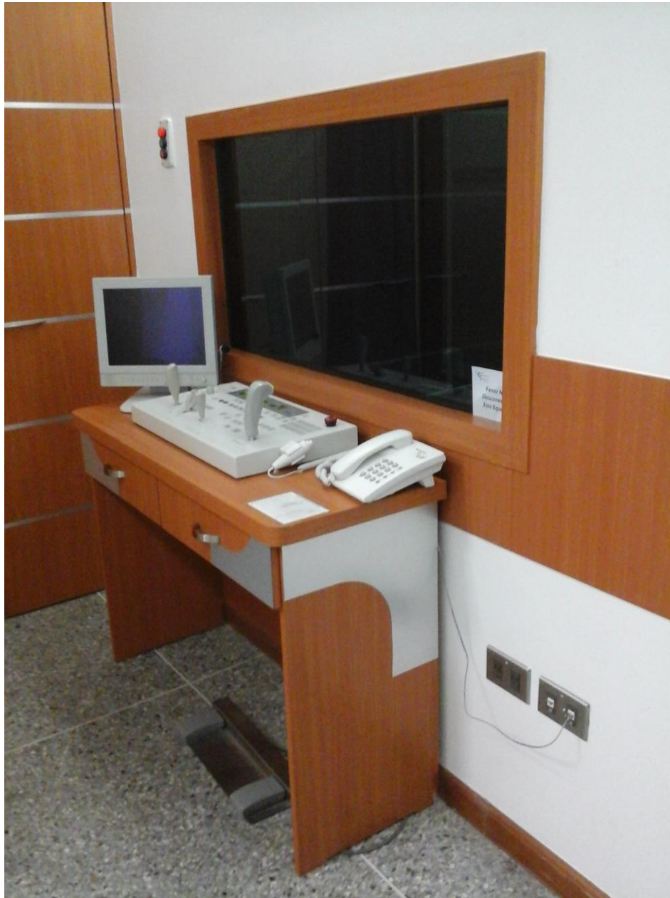
Figura 2.11: consola de mando de un equipo telecomandado, en la misma se puede observar los mandos de movimiento de la camilla, de la torre del tubo de Rayos X, los controles de apertura del colimador y los pedales de cine y fluoroscopio.
