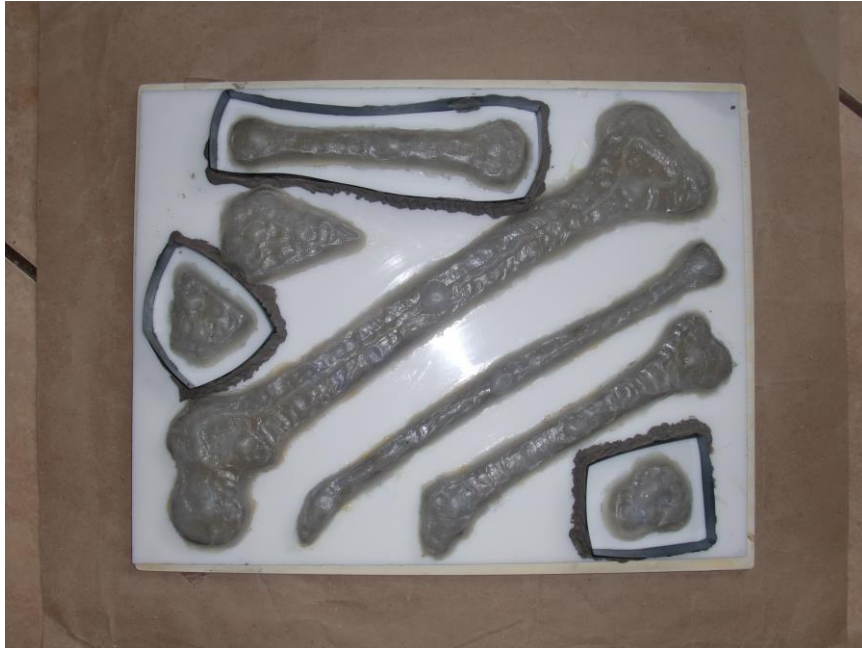
Figura 5.25: en la foto se muestran los bordes alrededor de las formas que fueron cubiertas con silicona.
