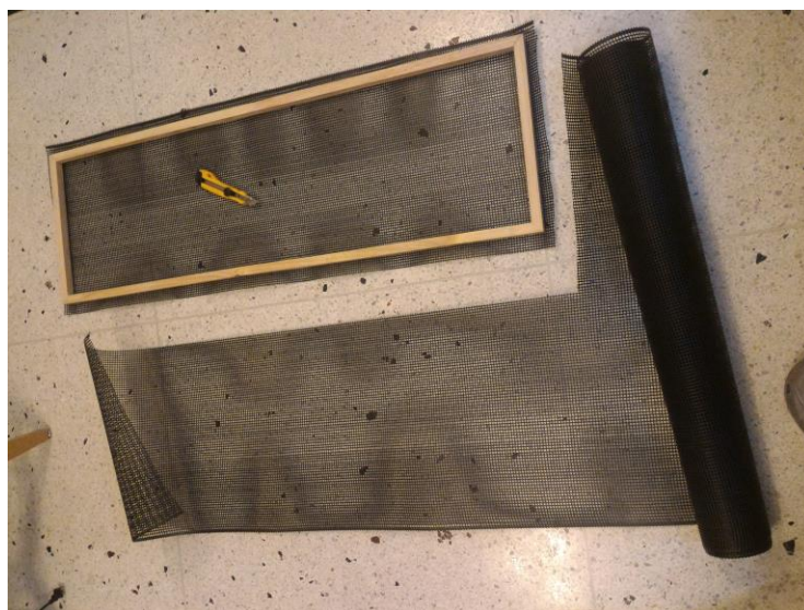
Figura 6.5: En la foto se muestra el corte realizado a la maya plástica.
