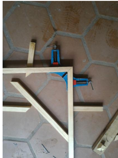
Figura 5.29: En las figuras se muestra el soporte que mantiene alineado a 90 grados los listones mientras se seca el pegamento.
