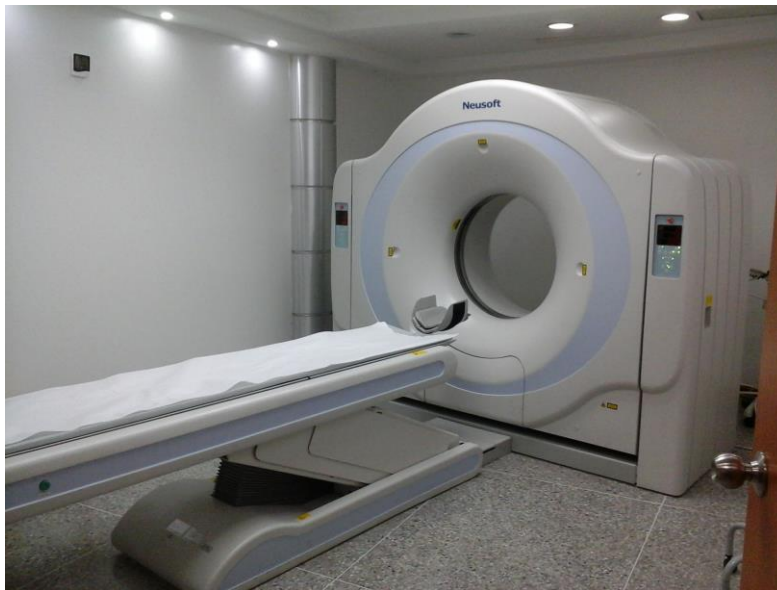
Figura 2.13: en la figura se observa un tomógrafo de 64 cortes, formado por la camilla y el gantry, donde se encuentra internamente el tubo, colimador y los detectores.
