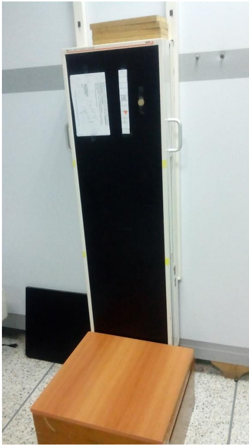
Figura 5.12: En las fotos se observan los artefactos de papel con contraste yodado sobre el bucky de miembros inferiores comercializado por AGFA, el mismo usa tres chasis, los artefactos se ubicaron en la parte superior del bucky.
