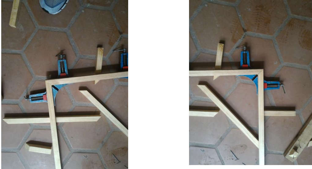
Figura 6.2: En las figuras se muestra el soporte que mantiene alineado a 90 grados los listones mientras se seca el pagamento.
