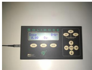
Figura 4.1: equipo detector solidose, en espera de una lectura, a la izquierda se observa el cable al detector.
