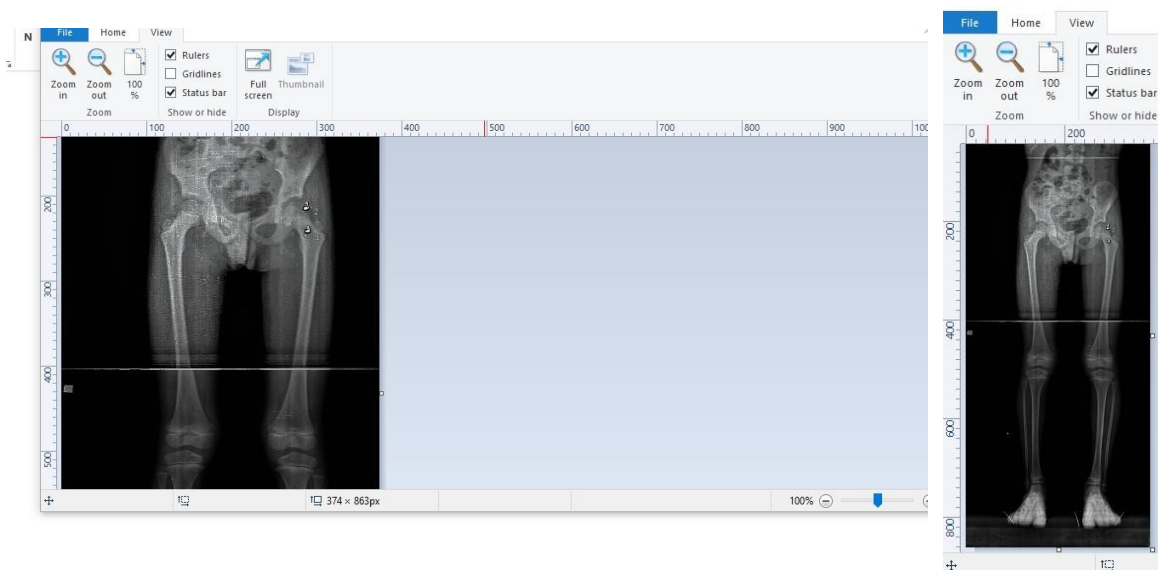
Figura 6.16: En las captura de pantalla se observa las imágenes superior e inferior ya fusionadas con la ayuda de la superposición de los marcadores radio-opacos que sirven de guía para ensamblar la imagen final.
