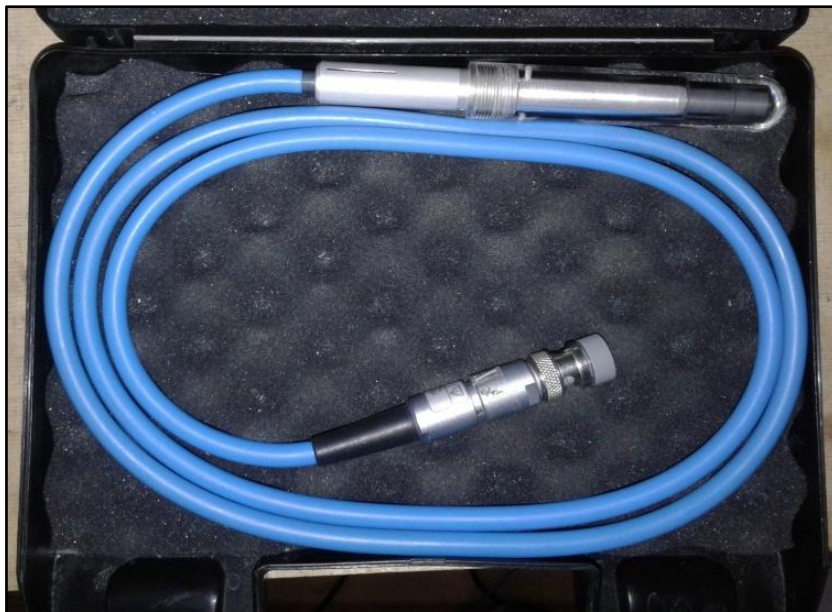
Figura 16: Cámara de ionización gaseosa tipo Farmer de 0,6 cm 3 .
