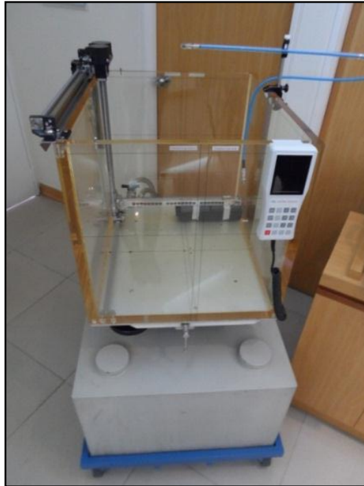
Figura 14: Maniquí de agua mp3 de la empresa PTW.
