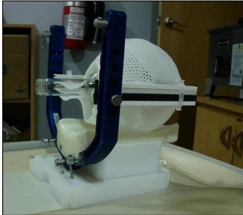
Figura 29: Marco para radiocirugía estereotáctica, con el maniquí esférico y la máscara termoplástica posicionados para la simulación.
