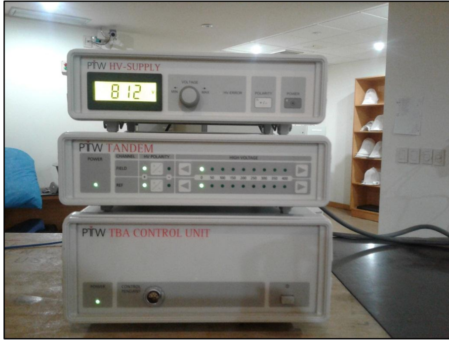
Figura 25: Montaje de la fuente de alto voltaje conectada al electrómetro dual TANDEM y a la unidad de control TBA.
