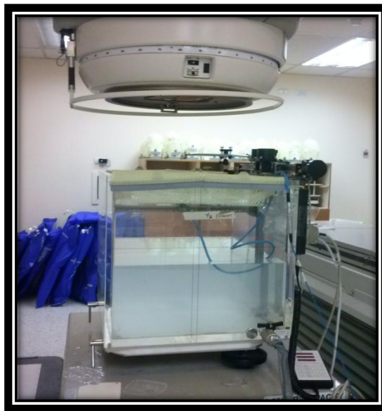
Fig. 29. Montaje experimental para la obtención de PDD y perfiles.
