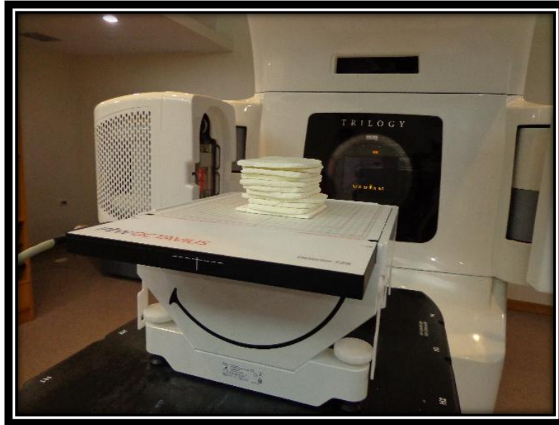
Fig. 38. Montaje en el sistema 2DArray para la obtención de perfiles y PDD con distintos grosores de Bolus.
