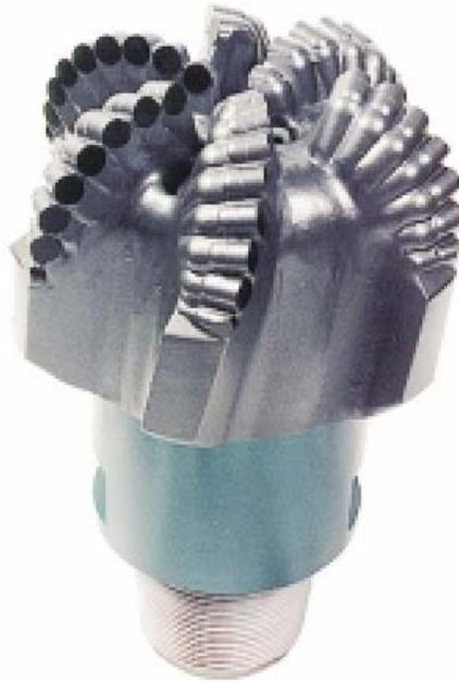
**Figura 13.26.- Mecha PDC de 8-1/2 pulgadas**
