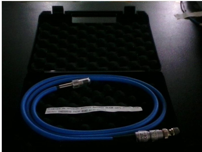
Figura 18: Cámara de ionización tipo Semiflex, marca PTW y serial 0157
