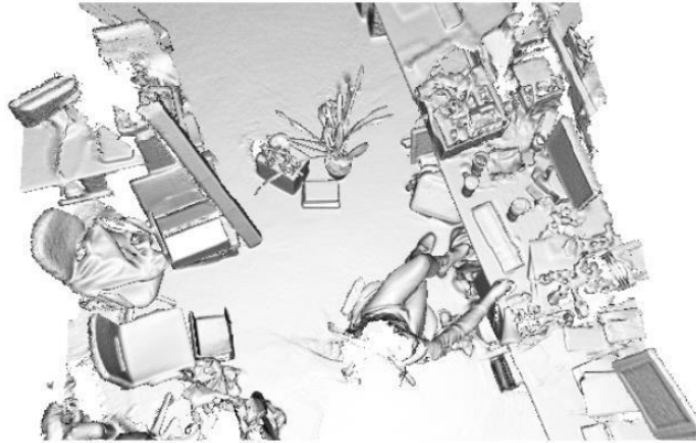
Figura 2-12 Reconstrucción de grandes escenas con KinectFusion [30].
