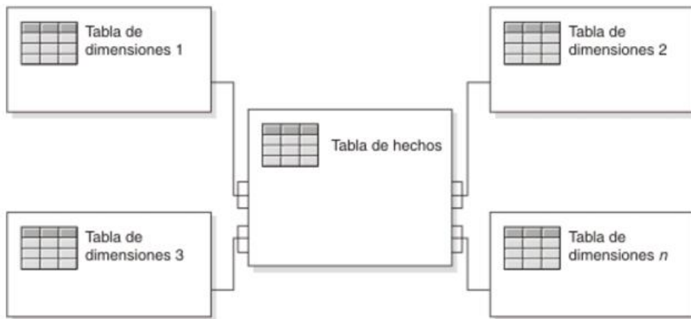
Figura 4: Esquema Estrella Fuente: (IBM Knowledge Center, 2009)
