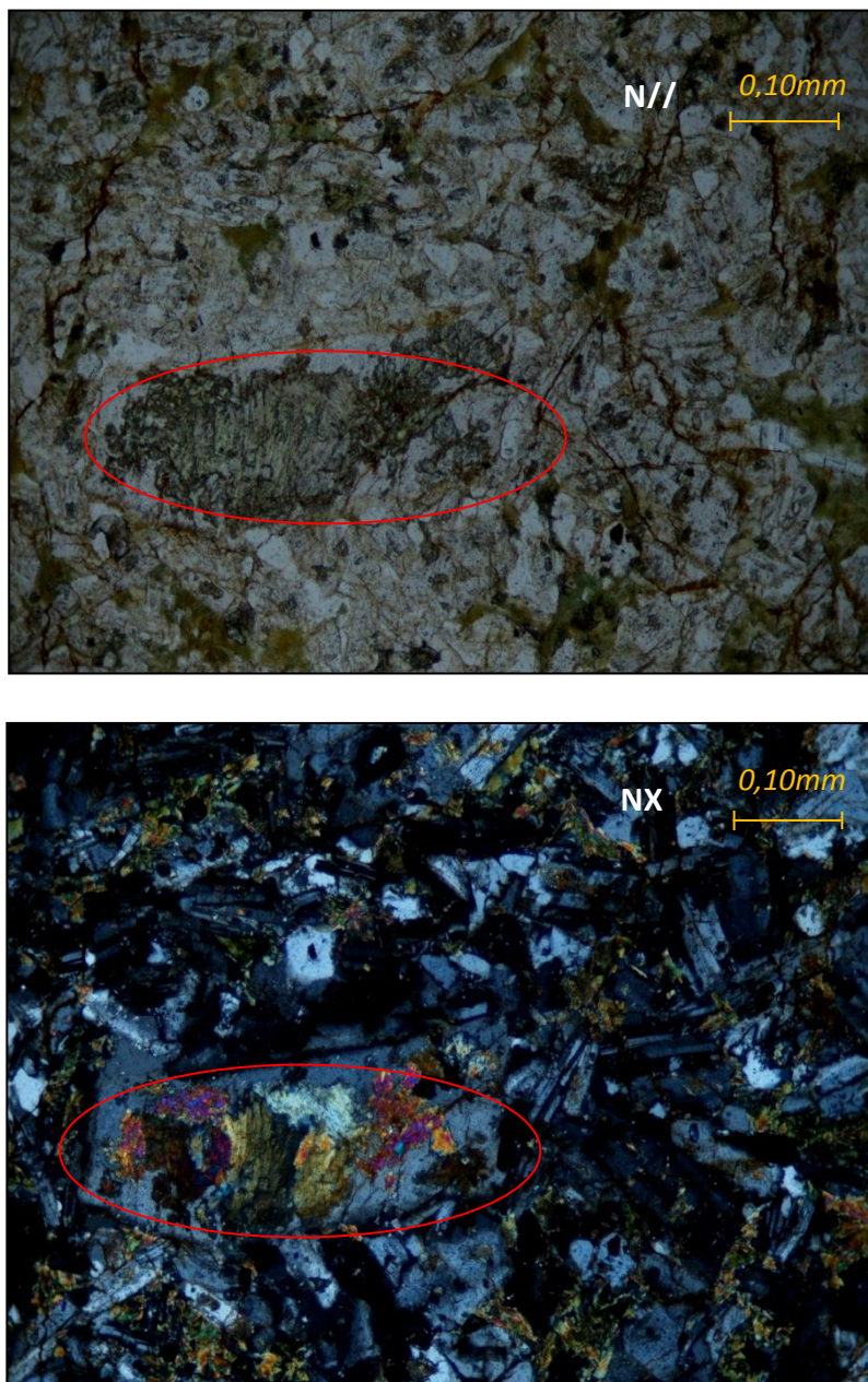
Fig.-51 .Fotomicrografías de la muestra IB-12 (metadiabasa porfídica). La fotografía revela una gran cantidad de plagioclasas con sus componentes cálcicos muy alterados a epidoto.
