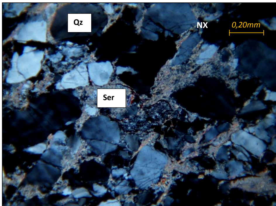
Fig. - 35 .Fotomicrografías de la muestra FV-33 (Esquisto czo-sericítico ultracataclástico). En la muestra domina la Textura granolepidoblásticas. Bandas de cuarzo, ortosa y albita con bandas de sericita.
