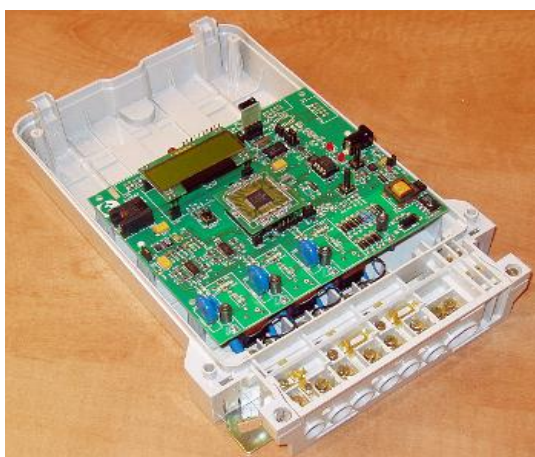
Figura 4. Vista interior de un medidor de energía electrónico
