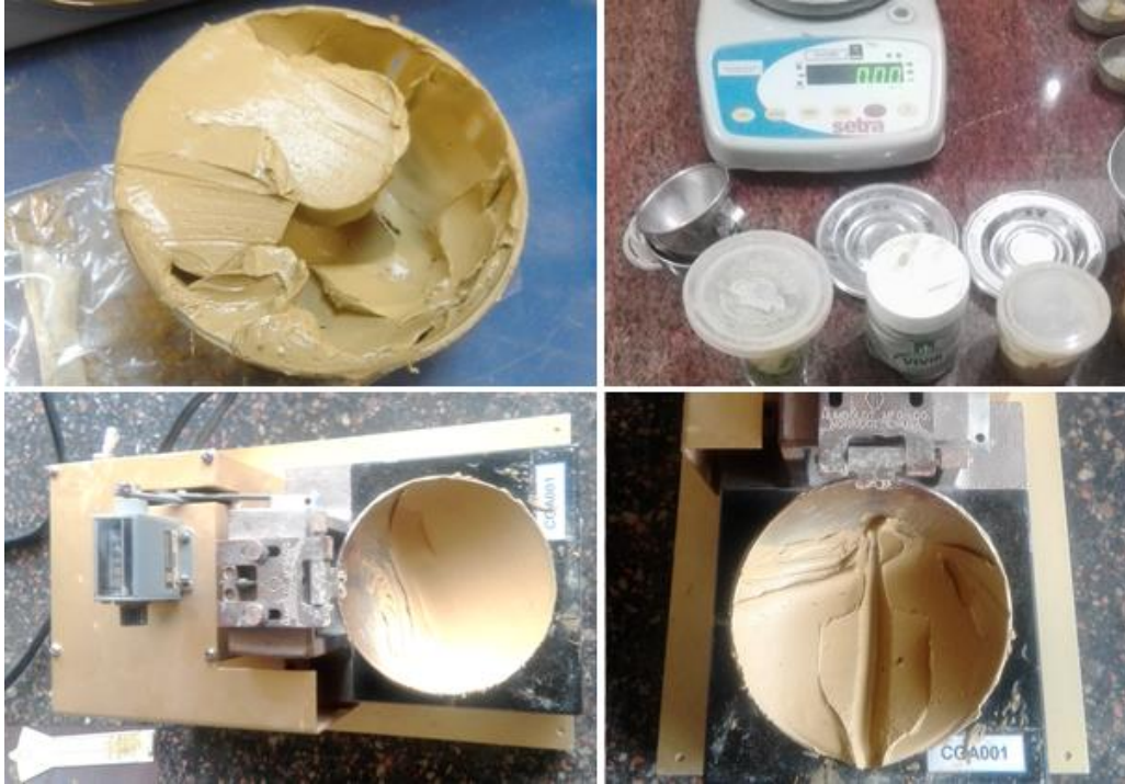
Figura 2.12. Proceso utilizado para la medición del límite líquido.
