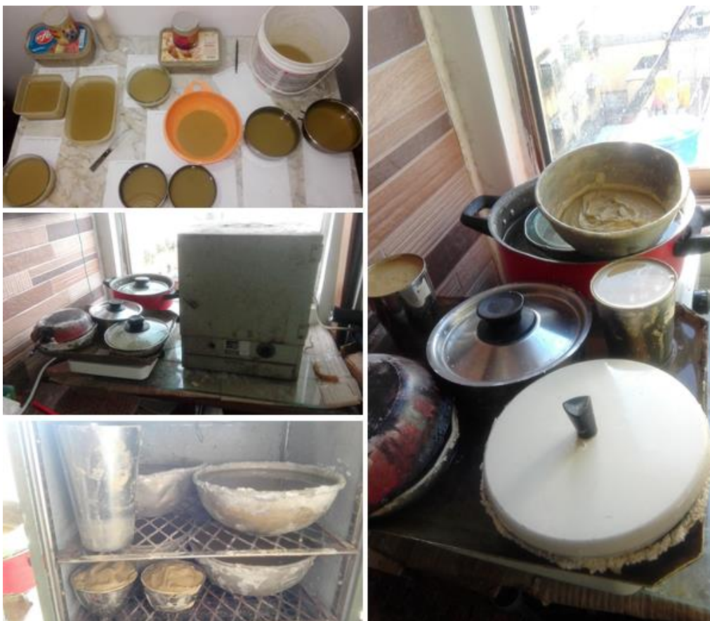
Figura 2.9. Proceso utilizado con la solución de NaCl a diferentes temperaturas y tiempo.
