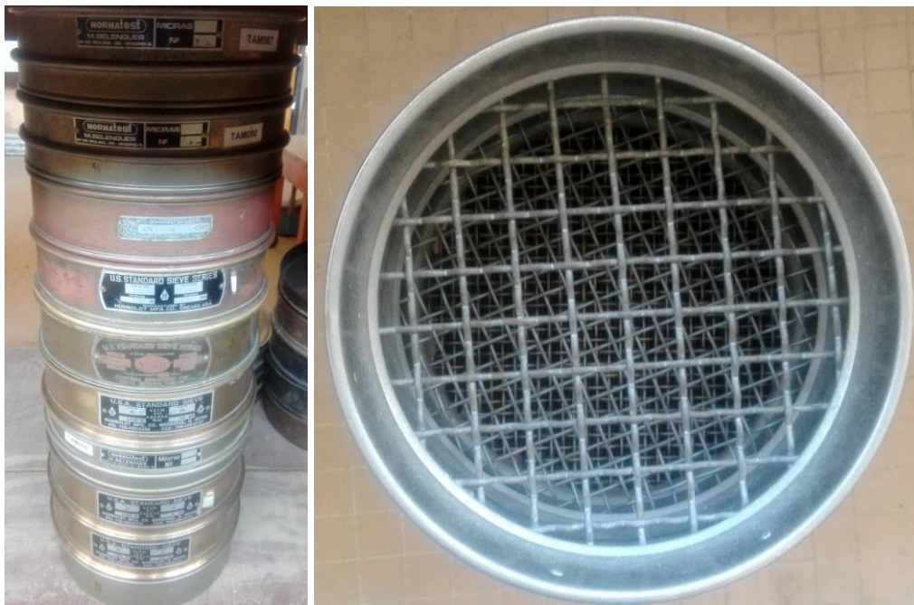
Figura 2.3. Juego de tamices en orden de abertura decreciente utilizado para el análisis granulométrico.
