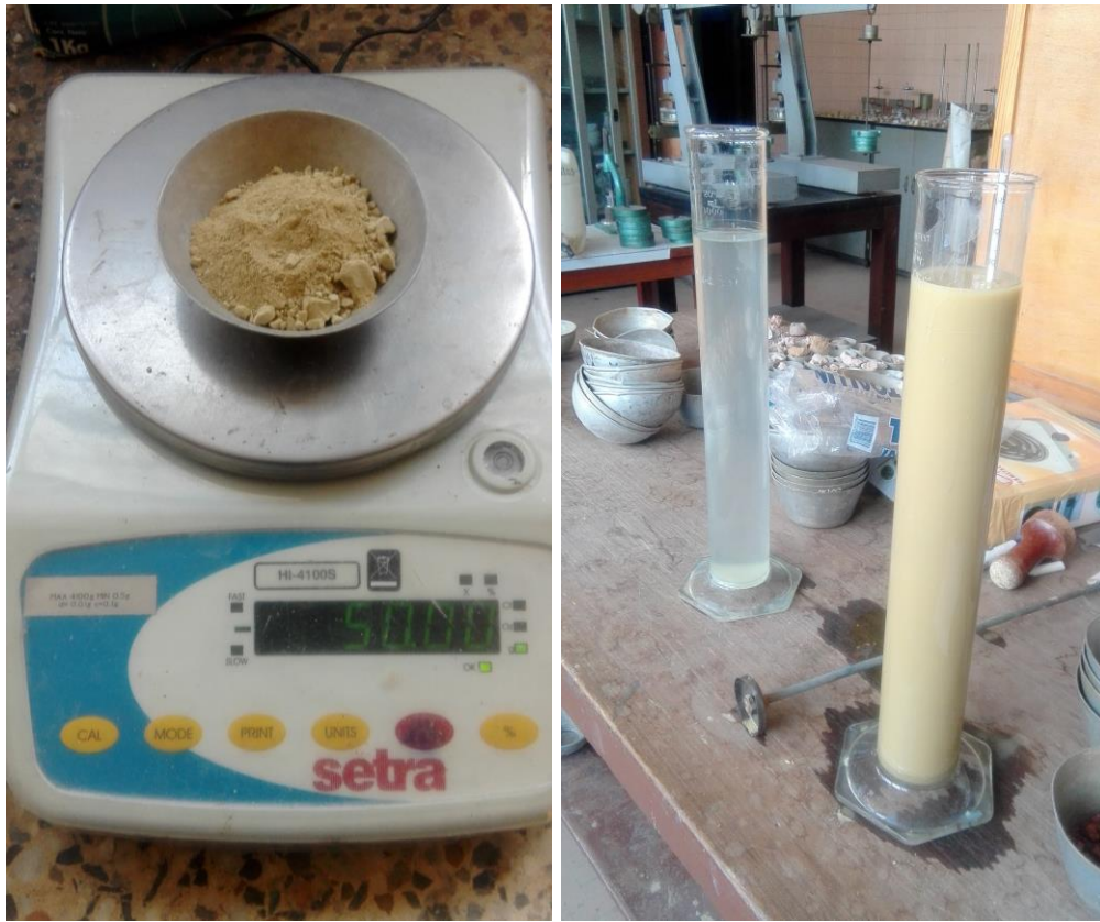
Figura 2.4. Imágenes que muestran el proceso de pesaje del material y medición de lecturas con hidrómetro.
