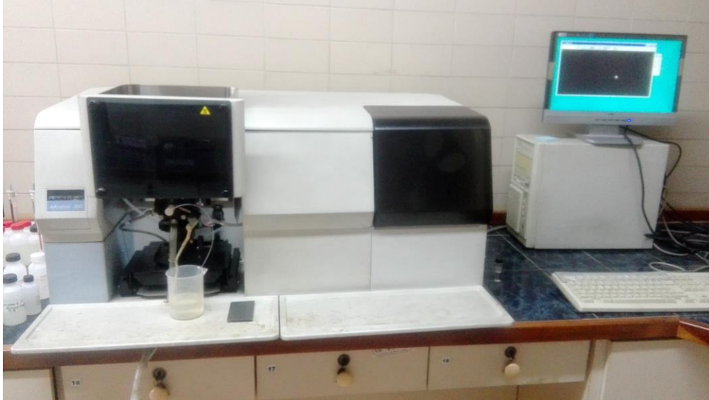
Figura 2.24. Equipo utilizado para la determinación de las concentraciones de Na y Ca en las muestras.
