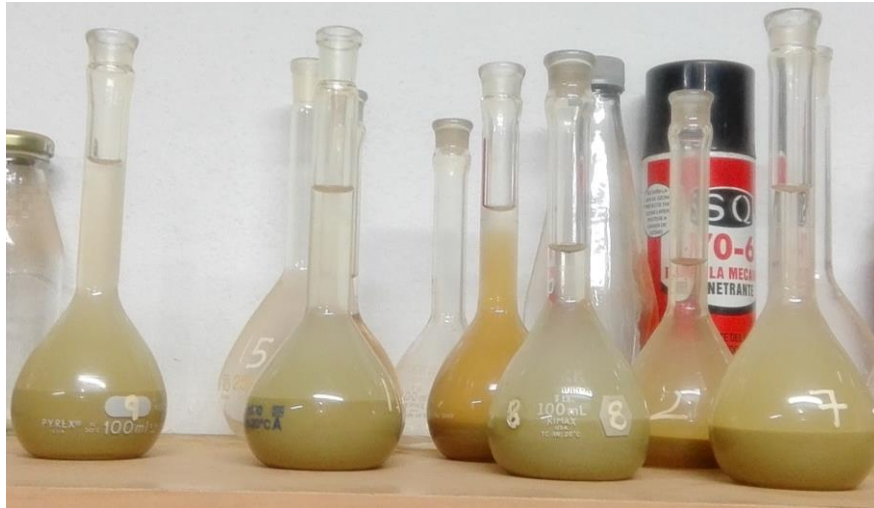
Figura 2.5. Imagen donde se observan las muestras dentro del balón aforado para su reposo, como parte del proceso utilizado para el cálculo de la gravedad específica.
