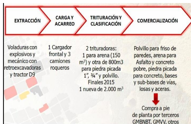
Figura nº 3 Descripción del proceso de producción. Fuente: Acosta M. Informe Minería de Campo 2015
