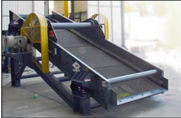
Figura nº10 Criba del tipo industrial Fuente: Telas Metálicas de Occidente, S.A de C.V.
