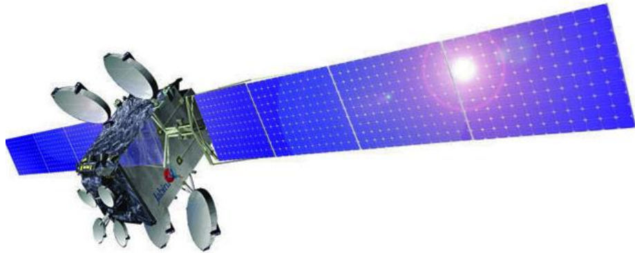
Gráfico 43. Ejemplo de reflectores en un satélite con banda Ka SpaceNews, Peter B. De Selding, 2012, Francia.
