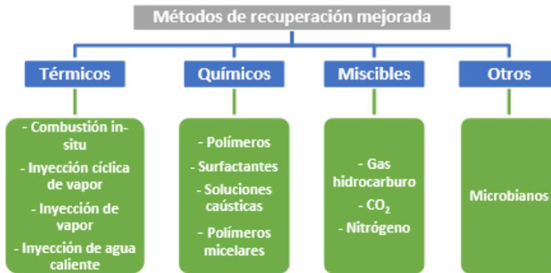
Fig 7. Clasificación de los métodos de recuperación mejorada (Satter, et. al., 1994)
