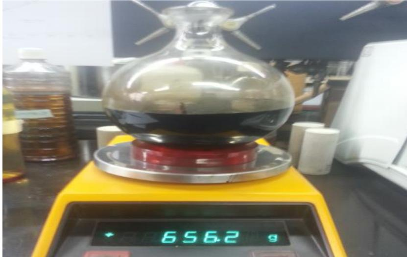
**Figura 13 Medición del peso de la muestra con agua**
