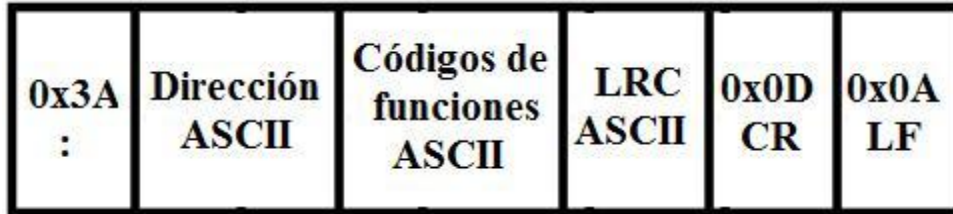
Figura 15. Transmisión de datos Modbus ASCII
