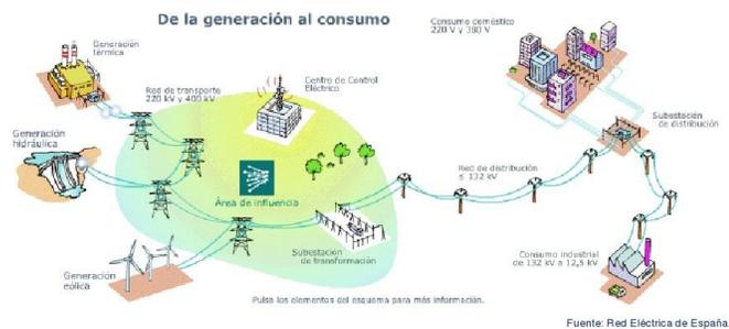
Figura 4.1. Esquema de un Sistema Eléctrico de Potencia
