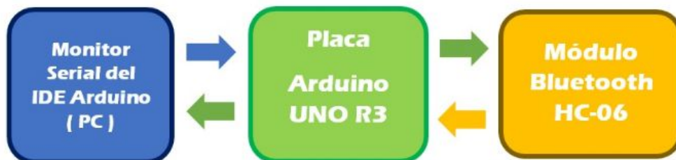
Figura 26: conexión para establecer los comandos AT
