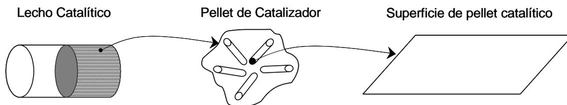
**Figura 3.6.-** Esquema de un reactor empacado con un lecho catalítico.
