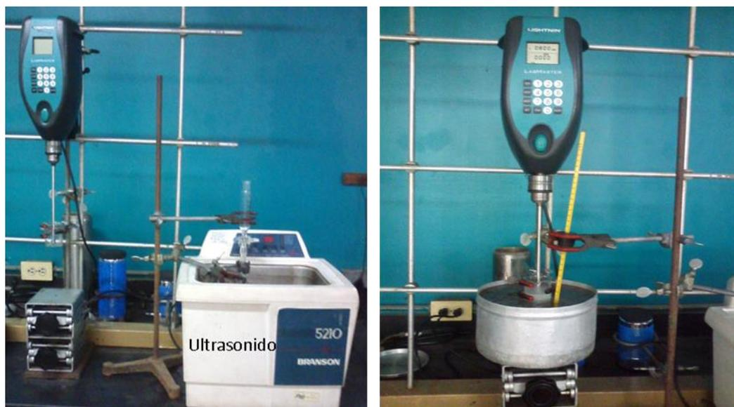
Figura 27. Montaje experimental a emplear en la elaboración de las microcápsulas con CX.
