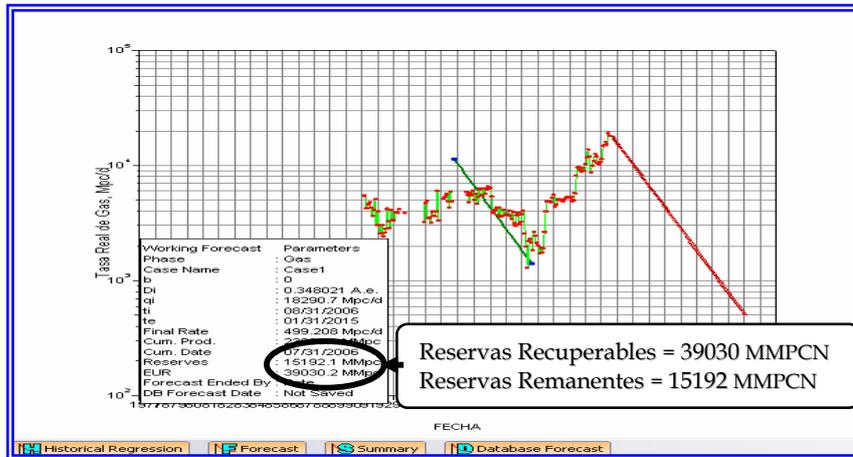
Figura 4. 26 Grafico de declinación de producción para estimar reservas con la herramienta Oil Field Manager (OFM).
