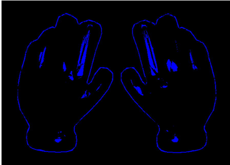
Figura 39: Imagen generada por la aplicación perceptualdiff , que resalta los pixeles con diferencias entre dos imágenes segun un algoritmo por percepción. Utilizando como base el modelo GloveLow_poly.obj . Con imágenes del modelo original y simplificado usando como parámetro 32 dimensiones.
