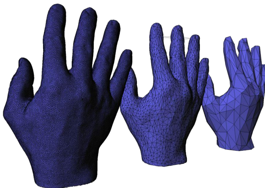
Figura 3: De izquierda a derecha: Ejemplo de la simplificación de malla con el modelo original y dos niveles diferentes de simplificación.
