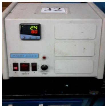
Figura 7. Controlador de temperatura.
