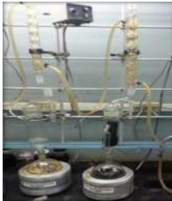
Figura 3. 8 Equipo de destilación-extracción Dean-Stark.
