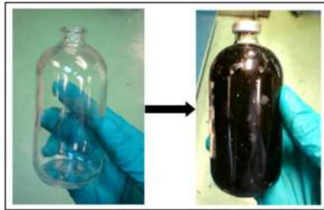
Figura 3. 6 Separador o vial usado para almacenar la muestra de crudo.
