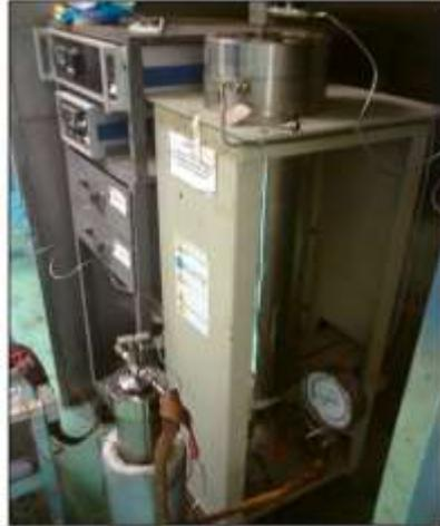
Figura 3. 4 Reactor utilizado para la recombinación del crudo.
