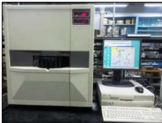
Figura 3. 9 Equipo permeámetro automatizado CMS, modelo 300
