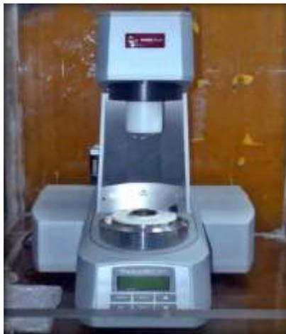
Figura 3. 2 Reómetro Physica MCR 301
