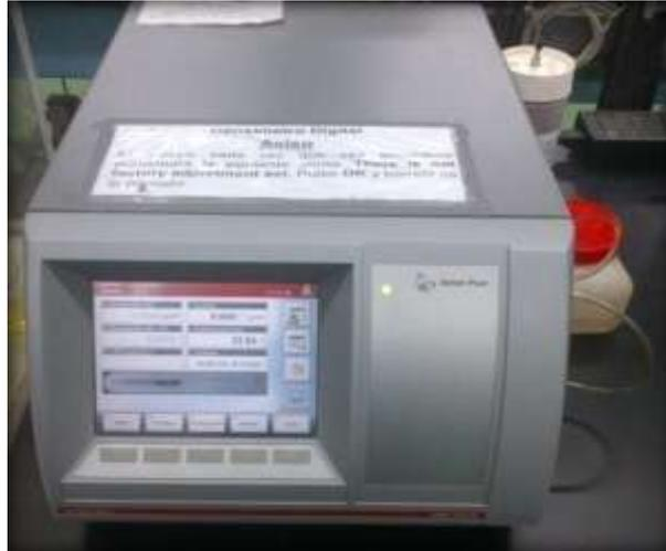
Figura 3. 1 Densímetro DMA 4500 M.
