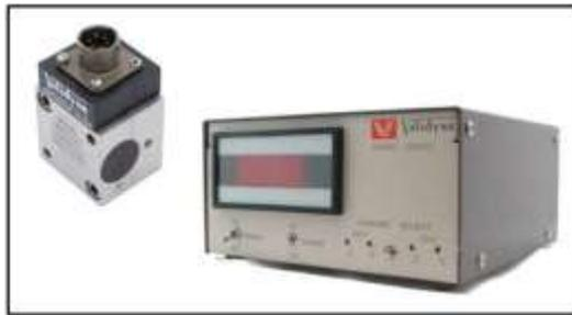
Figura 3. 11 Validyne y transductor de presión.
