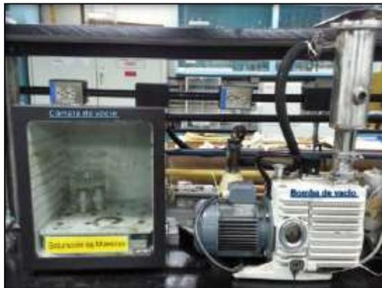
Figura 3. 10 Cámara de vacío.
