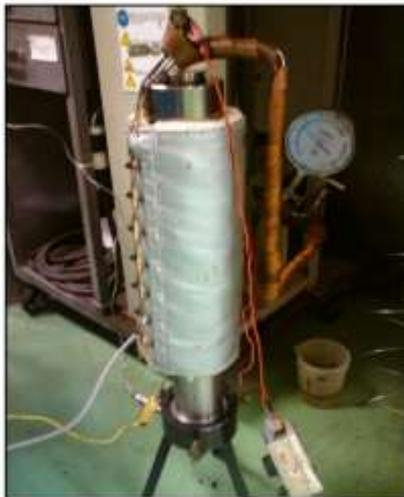
Figura 3. 5 Equipo utilizado para la inyección de crudo hacia el reactor.
